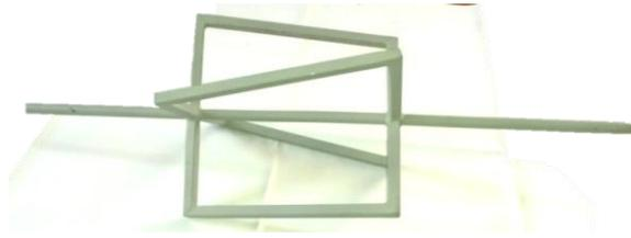
**Рисунок 1.** Схема теплообменника-мешалки
