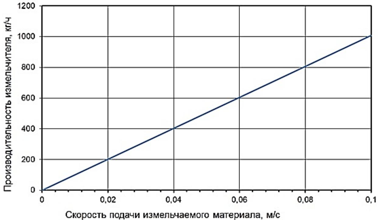
Рисунок 2.7 – Теоретическая зависимость производительности измельчителя от скорости подачи измельчаемого материала
