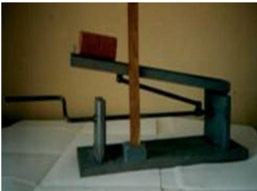
Рисунок 3.4 – Установка для определения коэффициента трения
