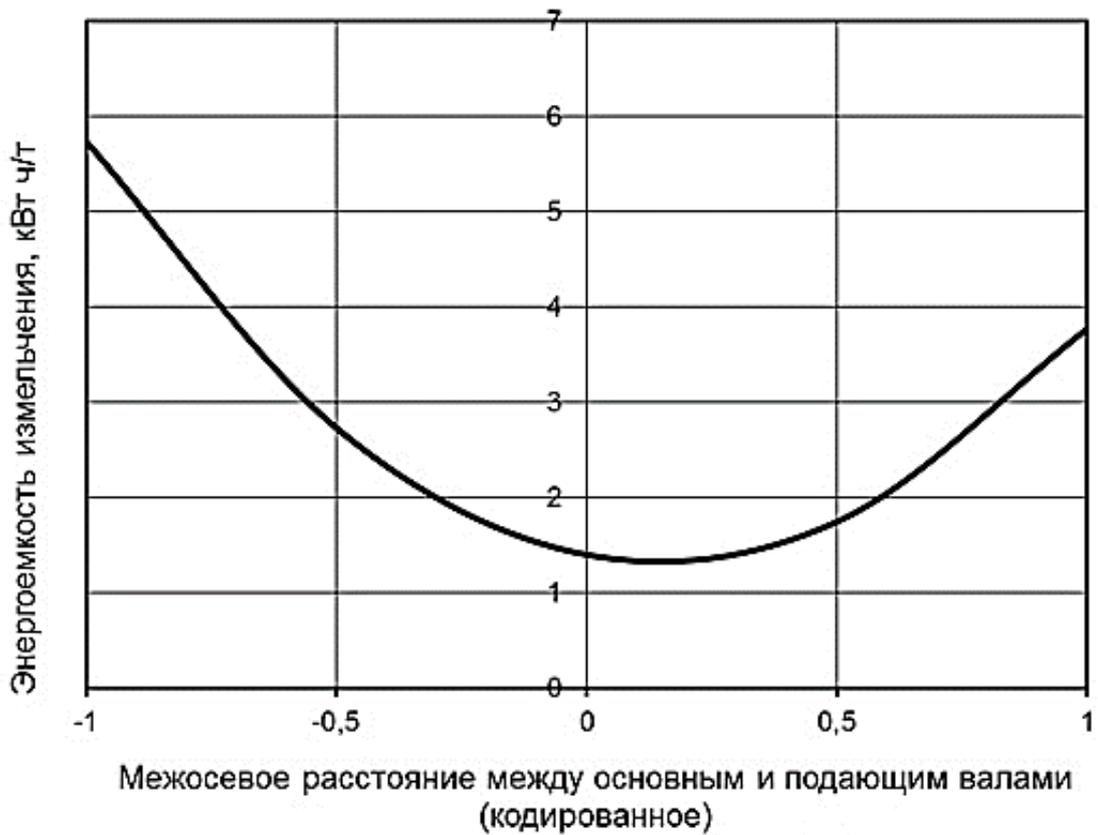
Рисунок 3.13 – Зависимость энергоёмкости измельчения от зазора между режущими и противорежущими ножами
