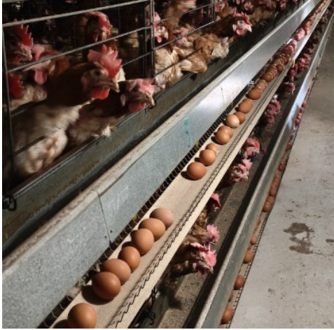
Рисунок 1 – Ленточный транспортер для сбора яиц под ярусом клеток
