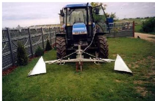
Рисунок 1.19 – Защитный фартук с металлическим кожухом
