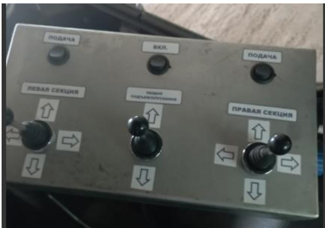
Рисунок 3.7 – Блок электрического пульта управления, установленного в кабине трактора
