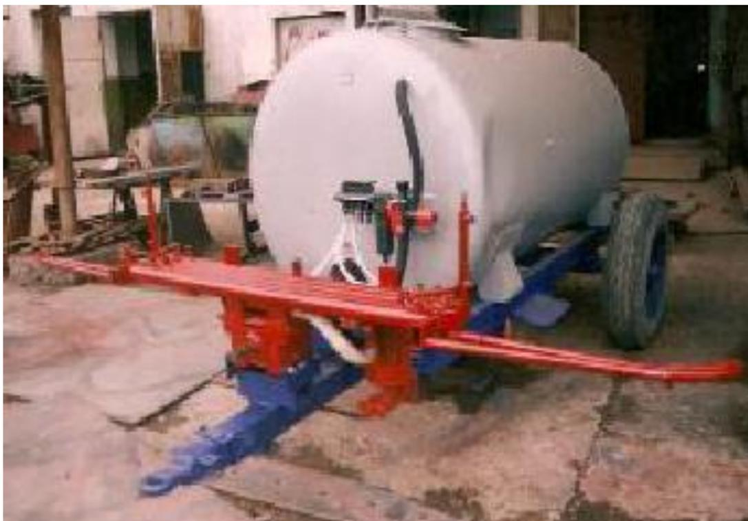
Рисунок 1.23 – Установка рабочего оборудования для внесения гербицида на прицепную тележку опрыскивателя ОПВ-2000
