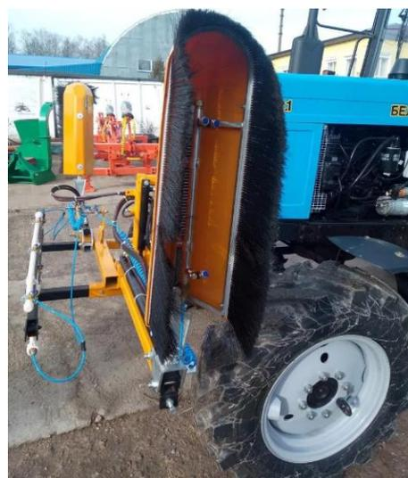
Рисунок 1.21 – Защитный фартук с пластиковым кожухом и ворсами
