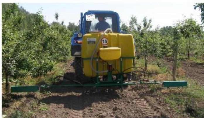
Рисунок 1.14 – Задняя навеска рабочего оборудования на трактор
