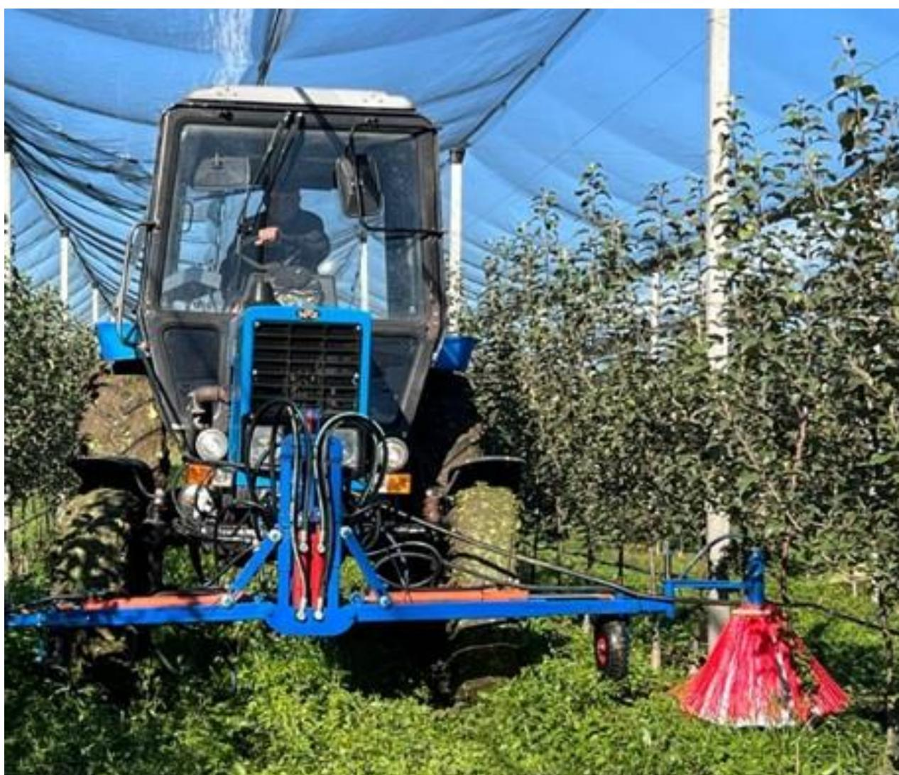
Рисунок 3.21 – Производственные испытания гербицидной установки
