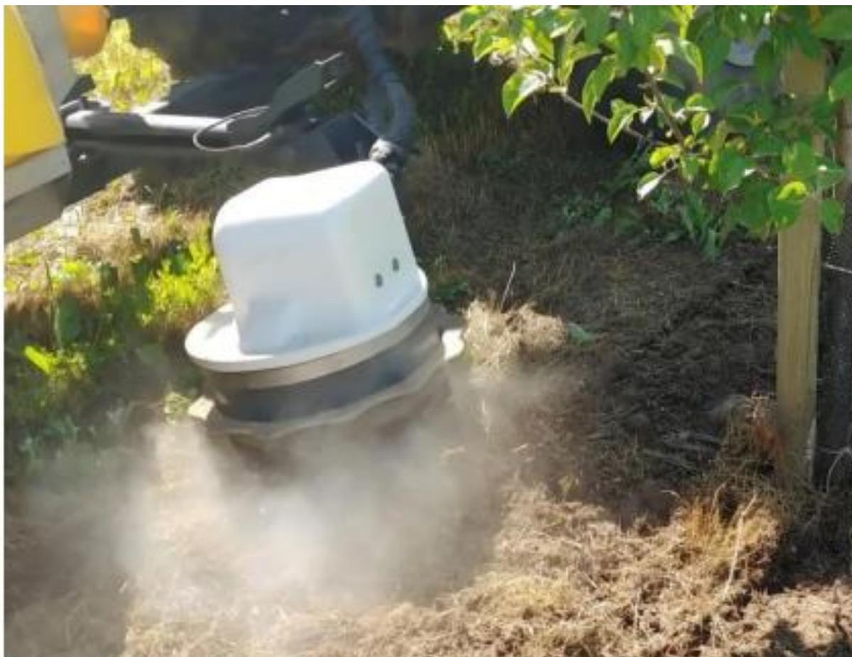
Рисунок 1.10 – Головка распылителя в работе
