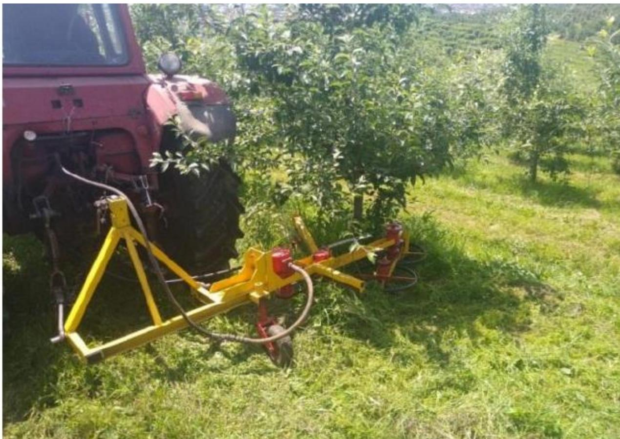
Рисунок 1.9 – Ротационная косилка конструкции ФГБОУ ВО Кабардино-Балкарский ГАУ
