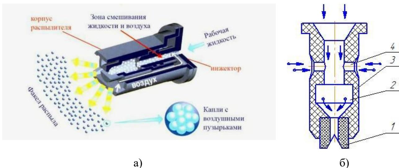
1 – минералокерамическое сопло; 2 – диффузор; 3 – корпус распылителя; 4 – канал забора воздуха
