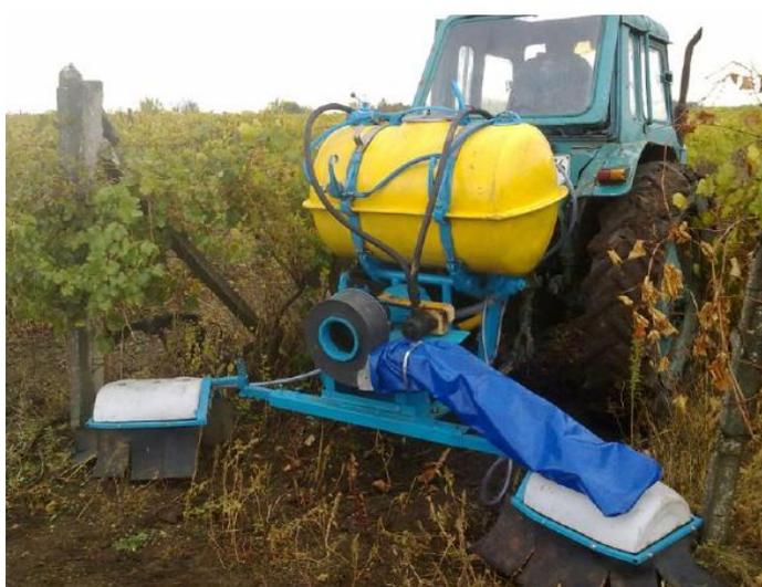
Рисунок 1.20 – Защитный фартук с пластиковым кожухом и плотным материалом
