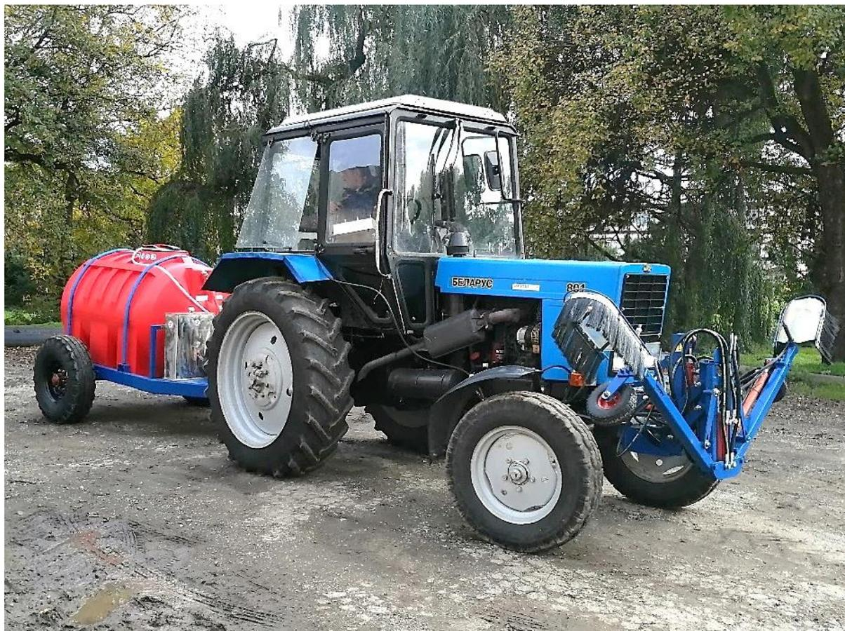
Рисунок 3.5 – Общий вид опытного образца гербицидной установки с пневмоакустическим распылителем
