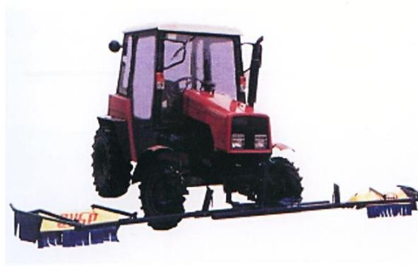
Рисунок 1.16 – Двухстороннее расположение отклоняющей штанги («ГЕРБИ/ДС - 2»)
