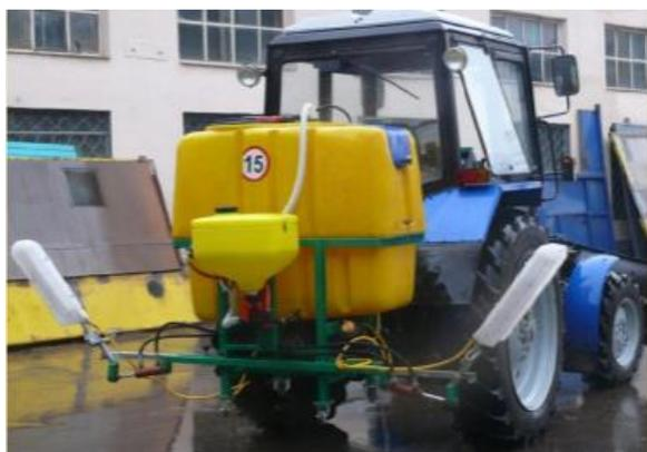
Рисунок 1.18 – Защитный фартук с пластиковым кожухом (конструкция ВИМ)
