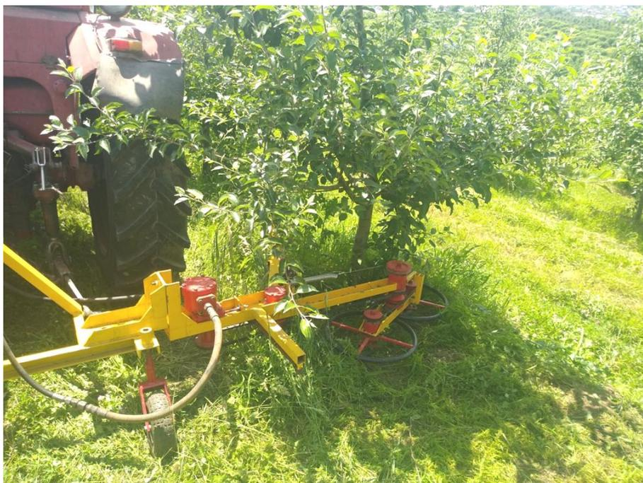
**Рисунок 2.** Двухроторная косилка в рабочем положении
