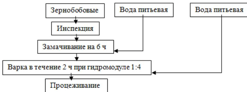
**Рисунок 1.** Технологическая схема получения аквафабы из фасоли белой, фасоли красной, чечевицы и нута
