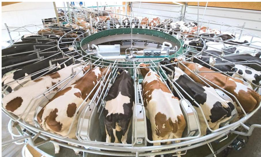
**Рисунок 1.** Доильное оборудование типа «Карусель»
