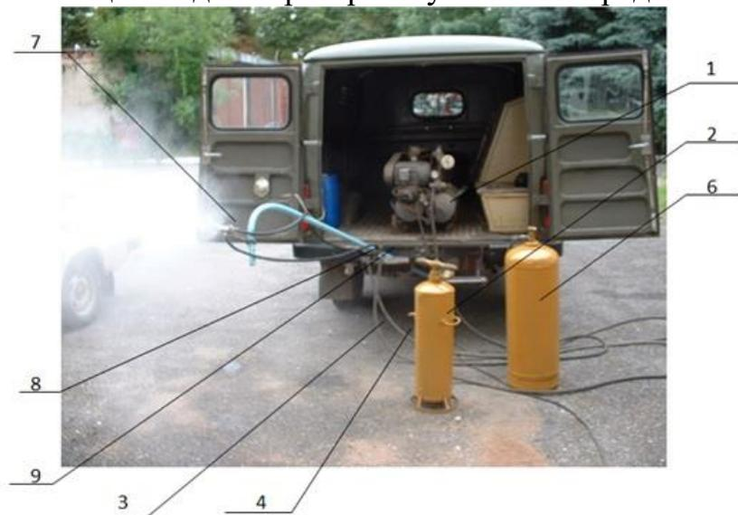
1 – компрессор; 2 – пневмогидро-аккумулятор; 3 – пневмошланг; 4 – гидравлический шланг; 5 – образцовые манометры; 6 – ресивер; 7 – пневмоакустический распылитель жидкости; 8 – вентиль для подачи воздуха; 9 – вентиль для подачи воды
