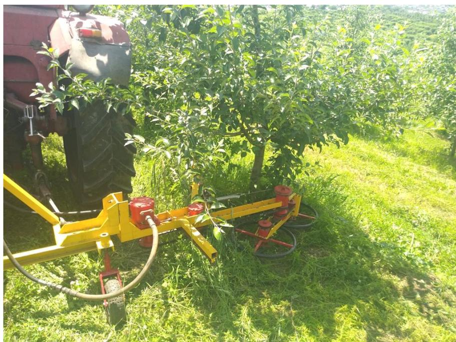
**Рисунок 2.** Двухроторная косилка в рабочем положении
