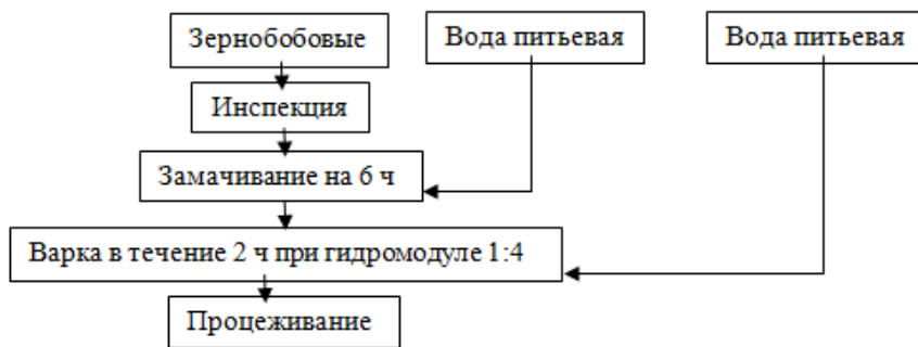
Рисунок 1. Технологическая схема получения аквафабы из фасоли белой, фасоли красной, чечевицы и нута
