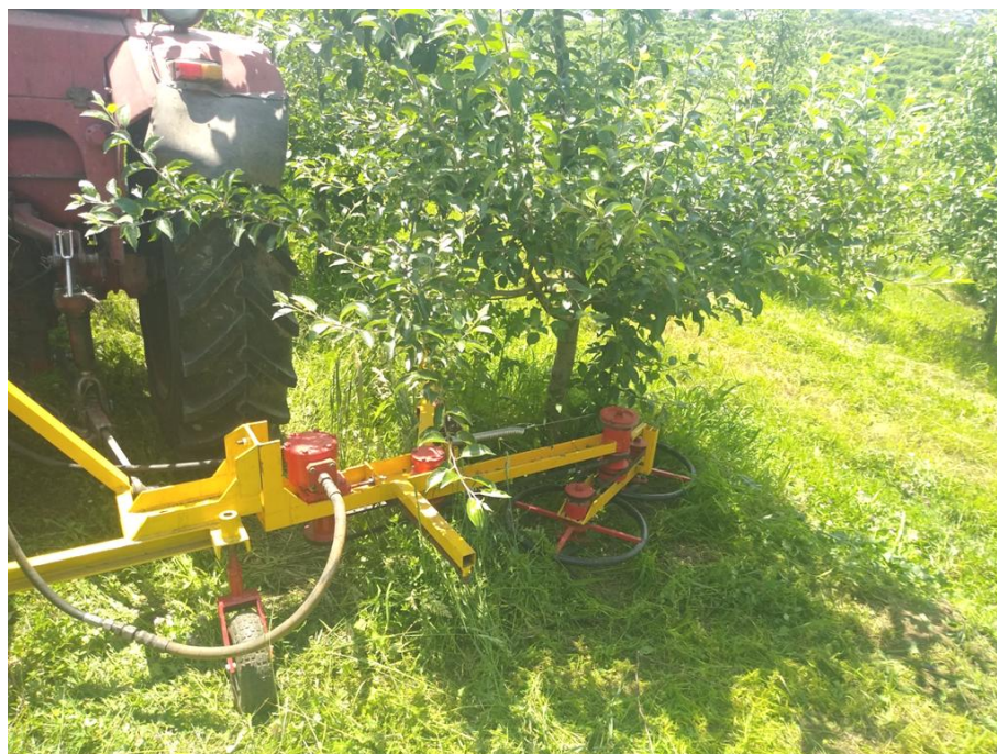
Рисунок 2. Двухроторная косилка в рабочем положении Figure 2. Two-rotor mower in working position
