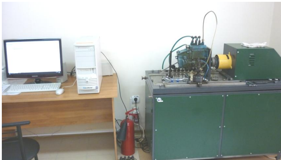
Рисунок 3. Стенд для испытания форсунок дизелей КИ-35478 Figure 3. KI-35478 Diesel Injectors Test Bench
