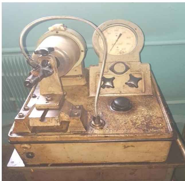
Рисунок 4. Прибор КИ-3333 для испытания и регулировки форсунок Figure 4. KI-3333 device for testing and adjusting injectors
