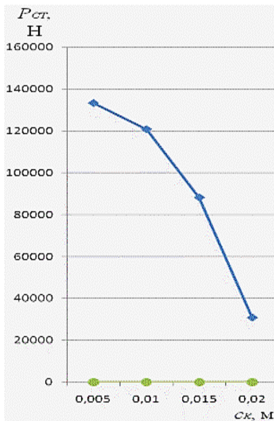
Рисунок 5. Закономерности смены сопротивления почвы разрыхлению P_{СТ} в зависимости от толщины консоли c_K Figure 5. Patterns of changes in soil resistance to loosening depending P_{СТ} on the thickness of the cantilever c_K
