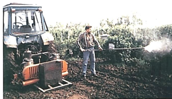
Рисунок 2. Индивидуальный туманообразователь в работе
