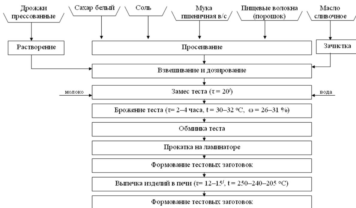
**Рисунок 3.** Технологическая схема производства галет с использованием пищевых волокон
