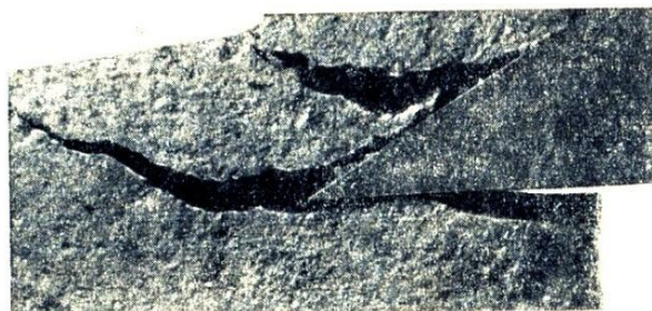
Рисунок 3. Трещинообразование при резании сильно увлажненного суглинка клином с углом резания \delta = 30^\circ [3]
