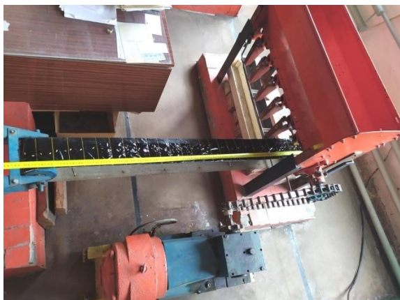
Рисунок 1 – Лабораторная установка для оценки равномерности зерновой струи
