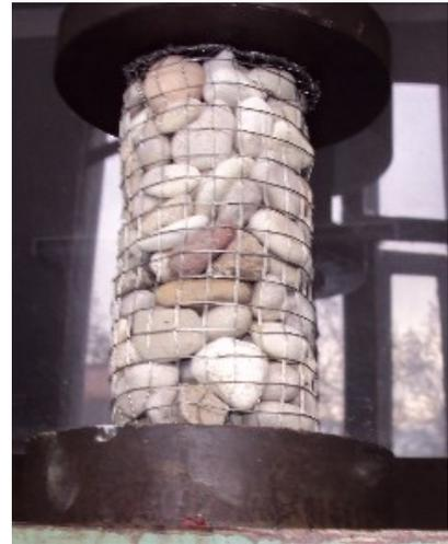
**Рисунок 2** – Общий вид модельных образцов на испытательном стенде
