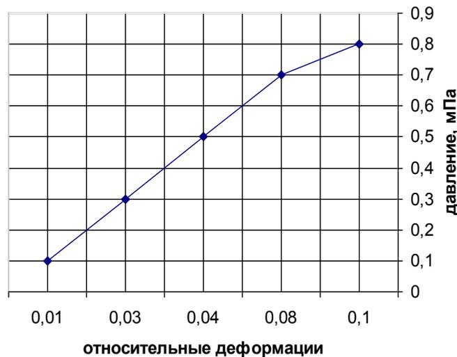
**Рисунок 4** – График зависимости напряжения от деформаций призматического габиона
