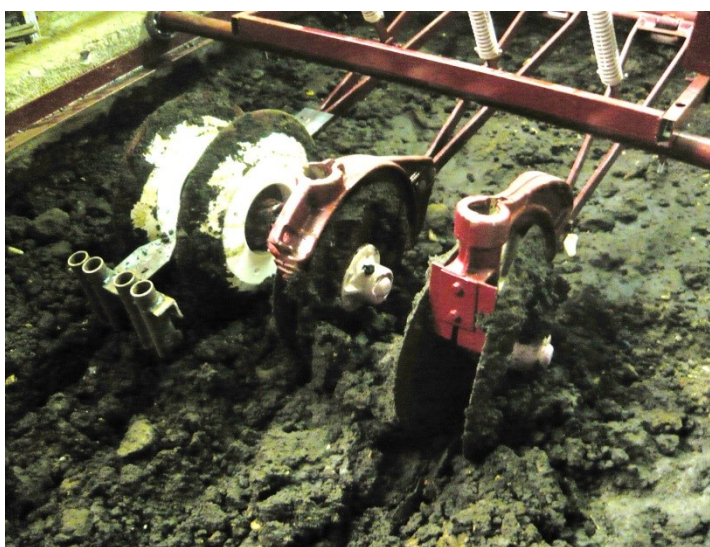
Рисунок 1 – Экспериментальный бороздоформирующий рабочий орган в почвенном канале.
