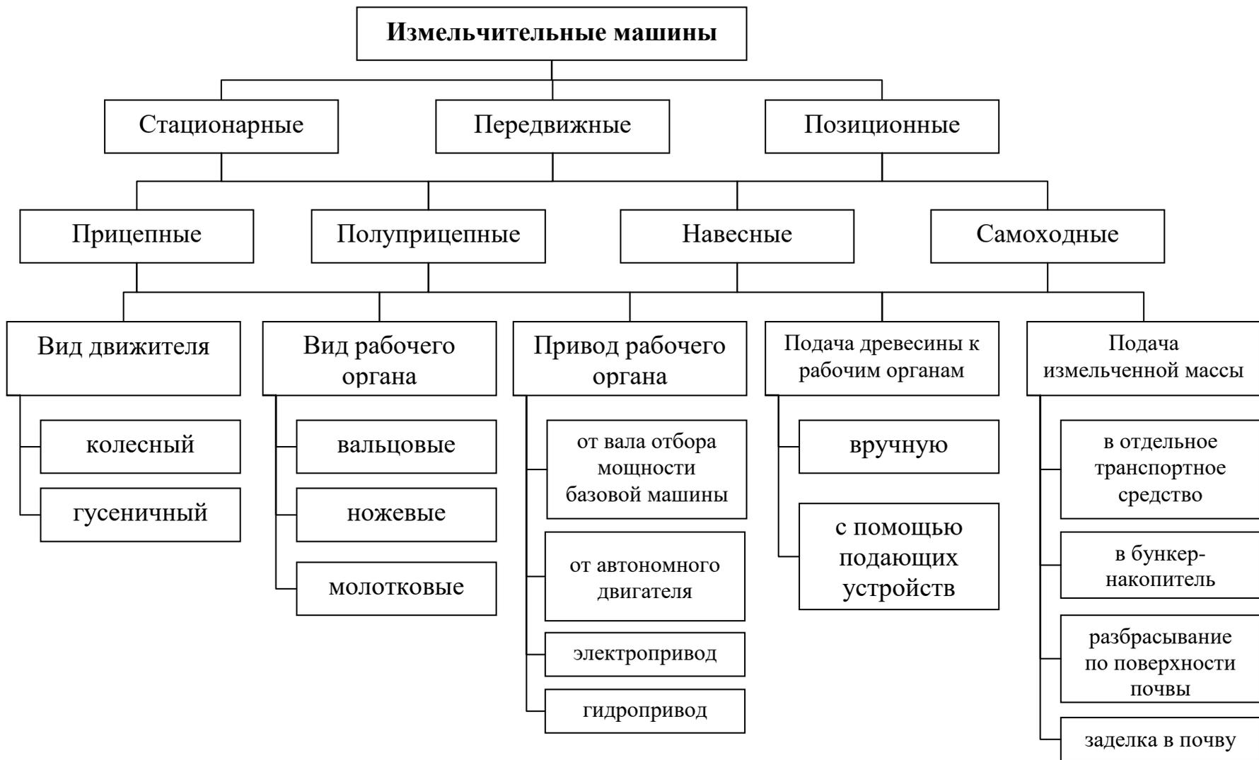
Рис. 1. Классификация машин для измельчения древесины.
