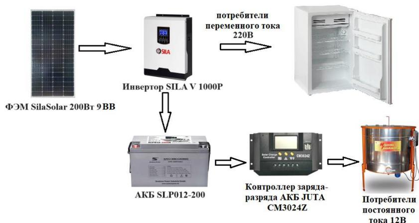
Рисунок 1. Структурная схема фотоэлектрической системы для кочевой пасеки
