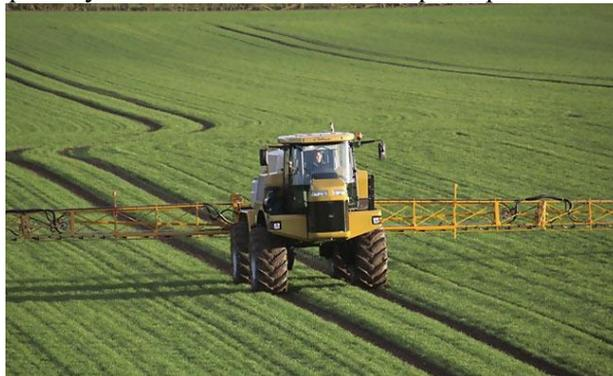
Рисунок 1 – Образование колеи при обработке посевов сельскохозяйственных культур самоходными штанговыми опрыскивателями
