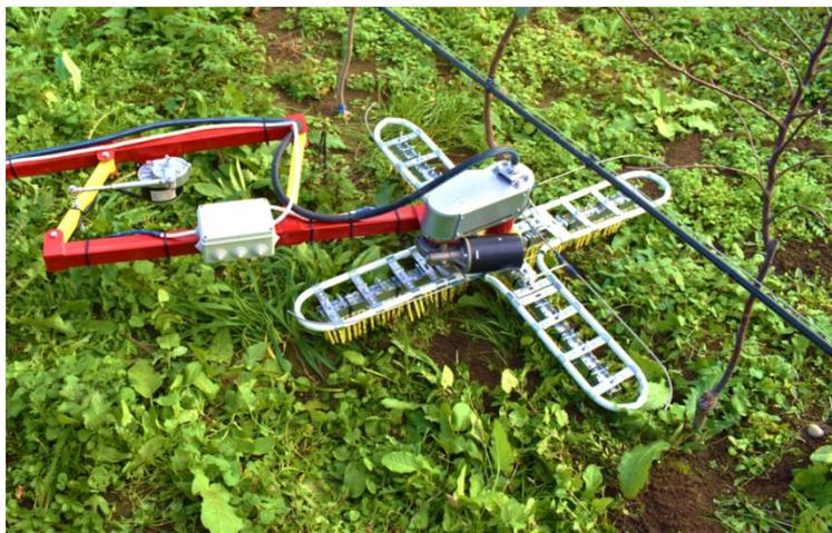
Рисунок 3 – Предварительные испытания опытного образца щеточного рабочего органа
