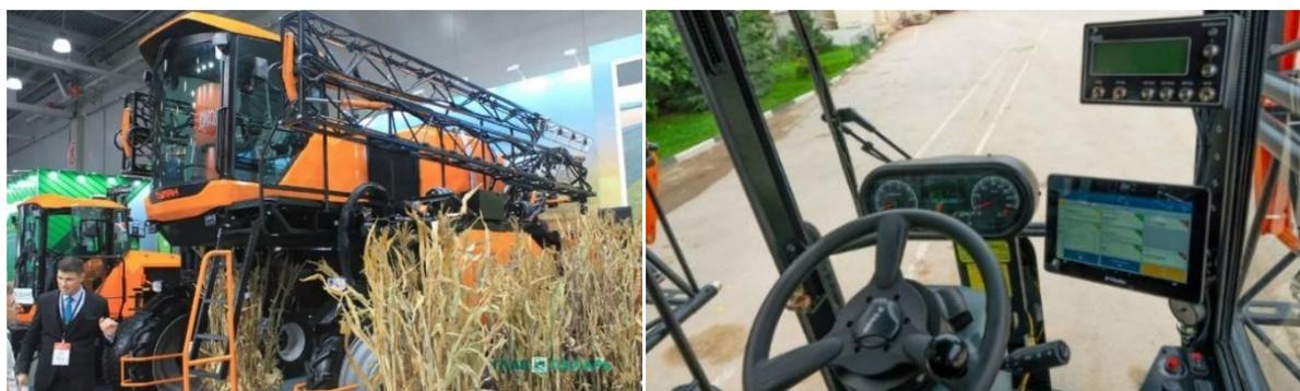
Рисунок 3. Агрегат высоко-клиренсный «Туман-4» на выставке «Агросалон-2024» с системой управления и автоматизированного контроля и управления технологическим процессом
