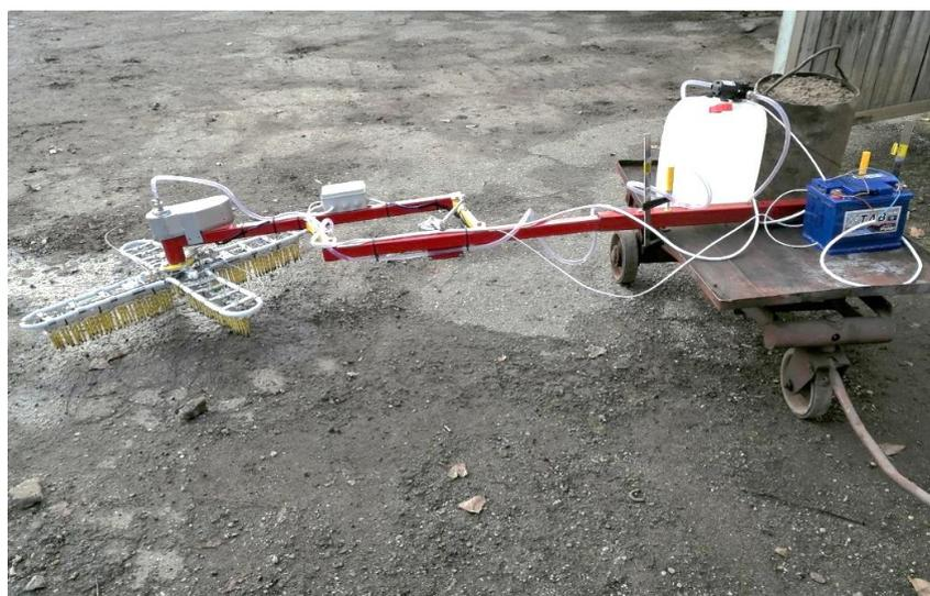
Рисунок 2 – Лабораторный стенд для пуско-наладки и настройки опытного образца щеточного рабочего органа
