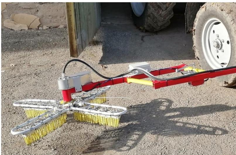
Рисунок 1 – Конструкция опытного образца щеточного рабочего органа для химической обработки приствольных полос многолетних насаждений
