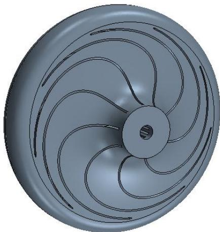
Рисунок 1. 3D-модель направляющего аппарата с безлопаточным диффузором
