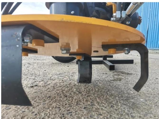
Рисунок 3. L-образные внутрь отогнутые ножи ФРО садовой почвофрезы DK-UT4
