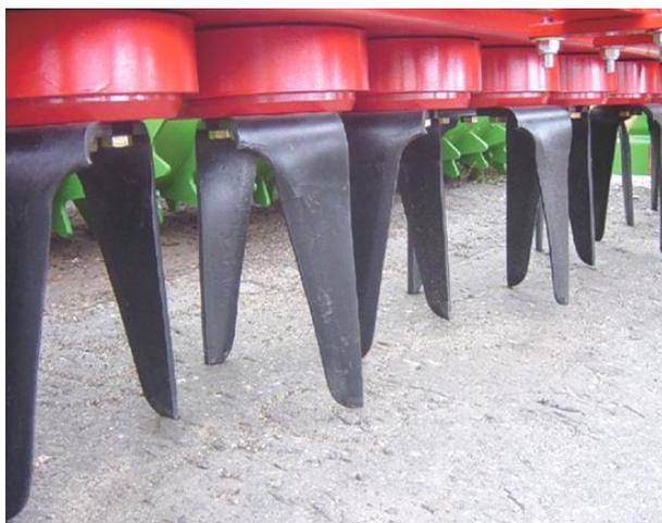
Рисунок 1. Ножи с косыми режущими кромками ФРО почвофрезы UNIA HERMES
