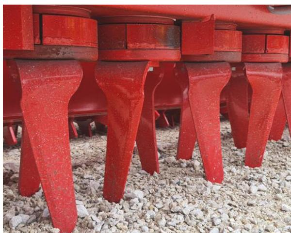
Рисунок 2. Ножи с косыми режущими кромками ФРО почвофрезы Egos-300
