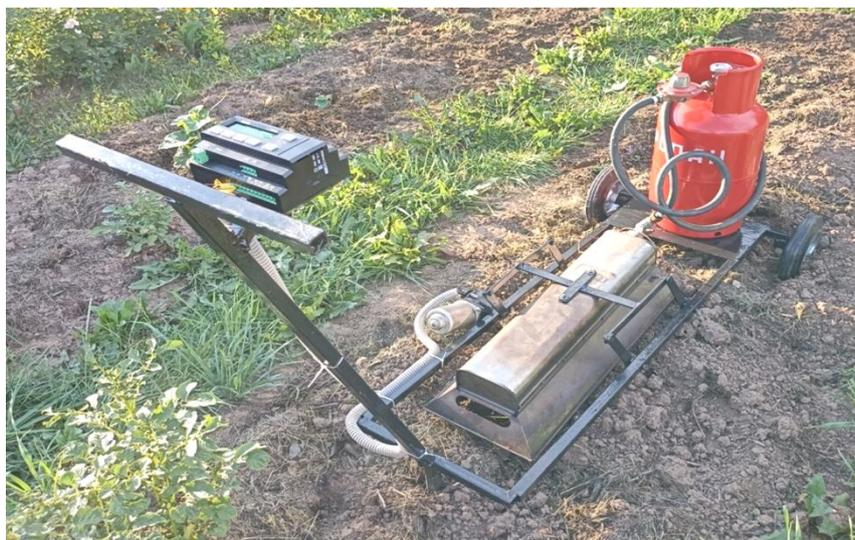
Рисунок 1. Роботизированная тележка для обеззараживания поверхностей ИК-излучением
