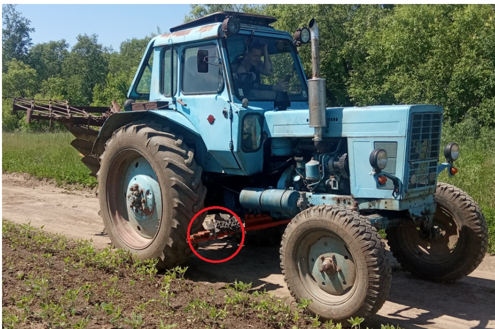
Рисунок 1 – Экспериментальный машинно-тракторный агрегат с устройством для вычищения колёсного движителя
