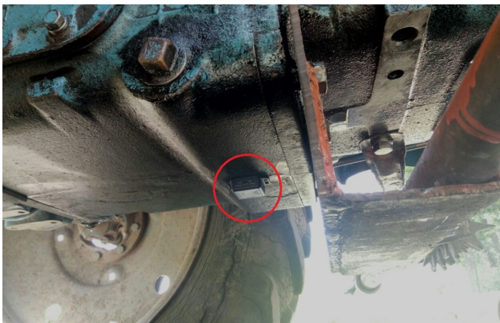
Рисунок 2 – Установка инклинометрического датчика на коробку передач трактора
