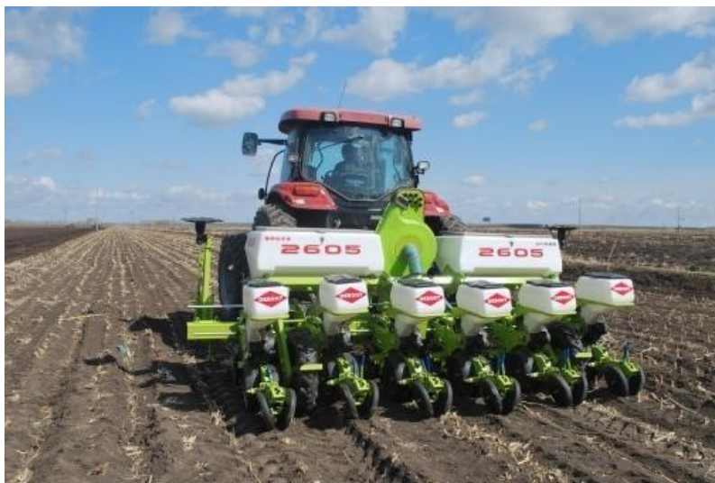
Рисунок 1 – Сеялка точного высева Debon Dawei 2605 с воздушным всасыванием и нулевой обработкой почвы
