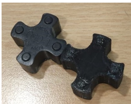
Рисунок 5 – Полученный элемент – готовая вставка упругой муфты эластичная топливного насоса
