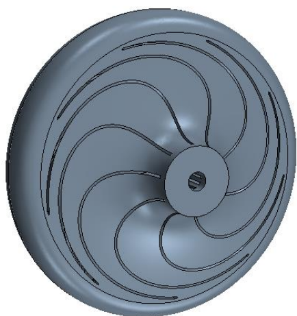
Рисунок 1 – 3D - модель направляющего аппарата с безлопаточным диффузором
