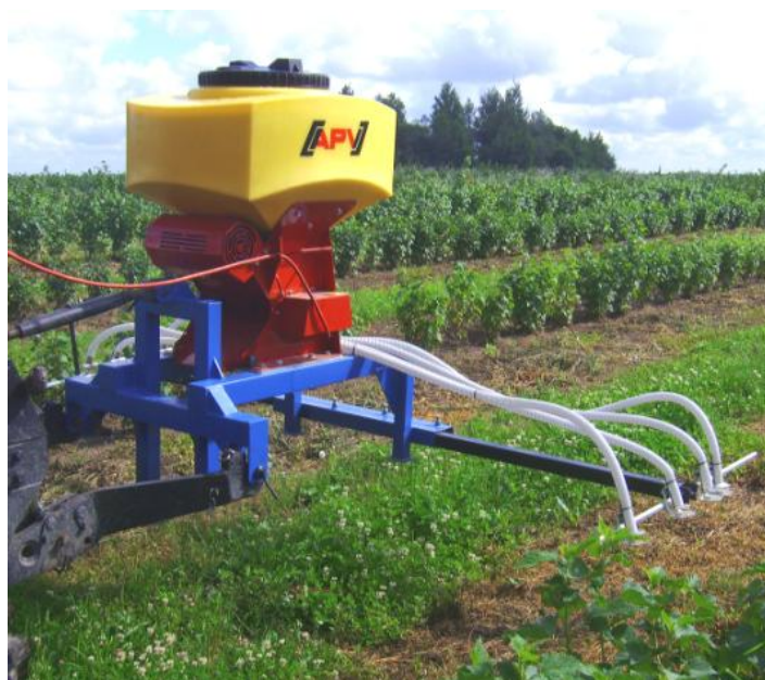
Рисунок 3 – Разбрасыватели минеральных удобрений серии ОКТОПУС
