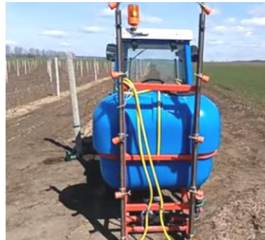
Рисунок 3 – Малогабаритные опрыскиватели: а – на базе трактора МТЗ-82 (опрыскиватель садовый БЛ-600); б – на базе трактора Т-25
