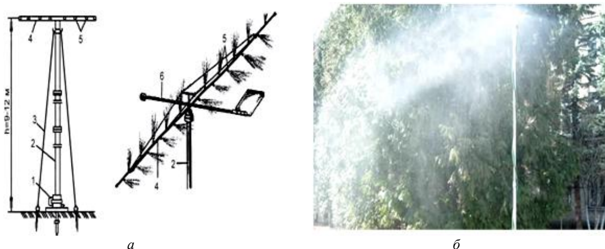
Рисунок 2 – Схема мелкодисперсной стационарной установки ВНПО «Радуга»
