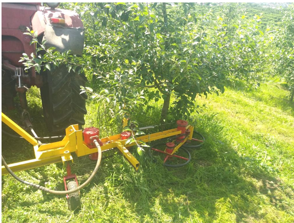
Рисунок 2 – Двухроторная косилка в рабочем положении
