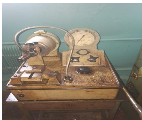
Рисунок 3 – Прибор КИ-3333 для испытания и регулировки форсунок
