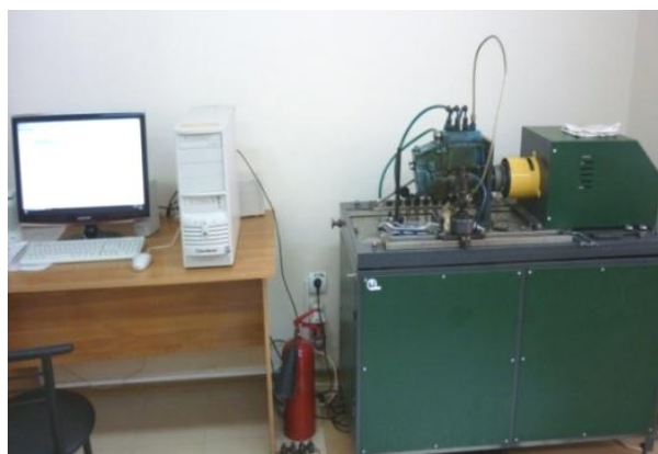
Рисунок 2 – Стенд для испытания форсунок дизелей КИ-35478
