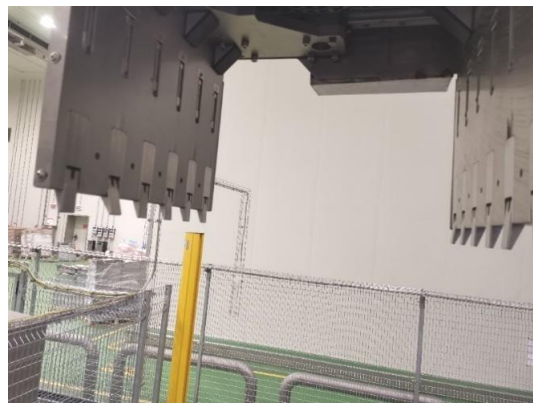
Рисунок 1 – Фото захвата робота ABB
