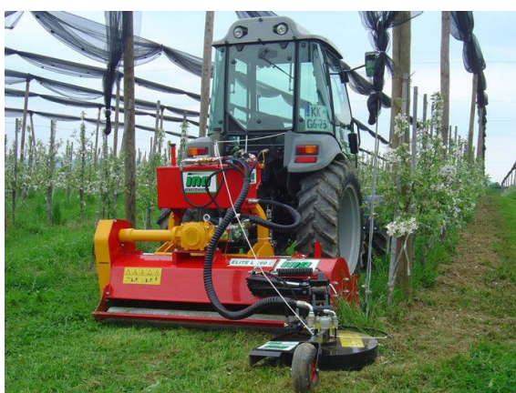
Рисунок 2 – Косилка-измельчитель с выдвижной секцией для ухода за приствольными полосами плодовых насаждений
