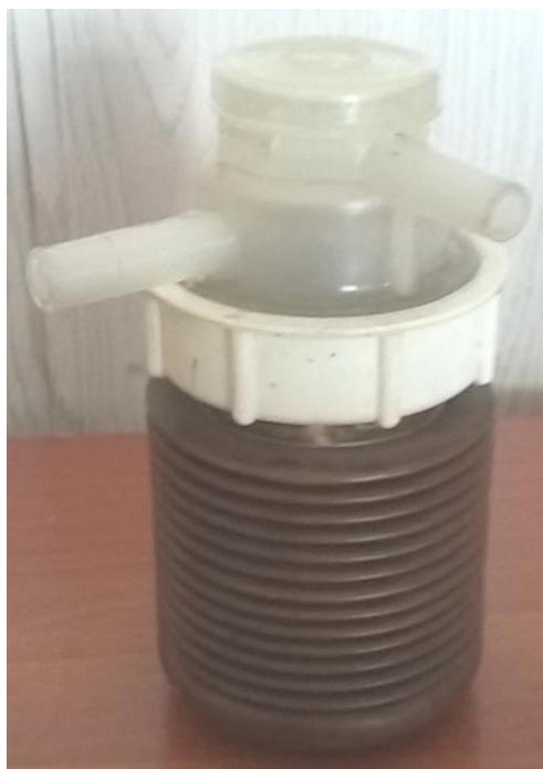
Рисунок 4 – Пульсатор доильного аппарата АДВ-Ф-1А
