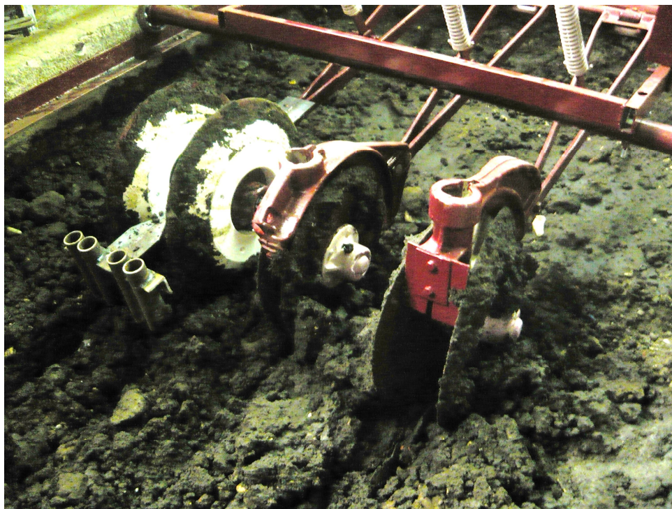
Рисунок 1 – Работа сошника в переувлажненной почве
