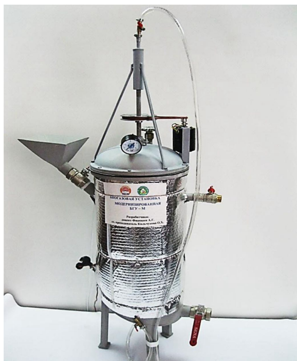
Рисунок 3 – Общий вид биореактора лабораторной установки
