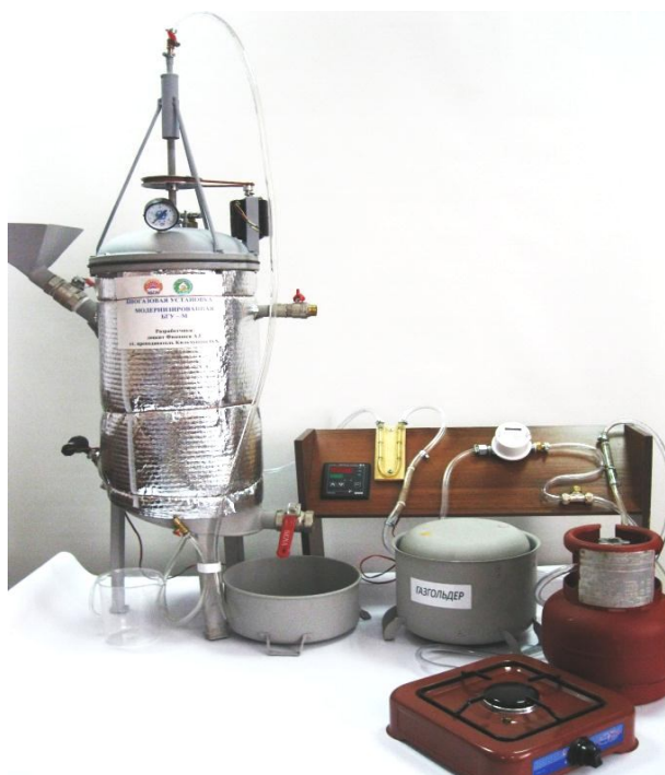
Рисунок 2 – Общий вид лабораторной биогазовой установки
