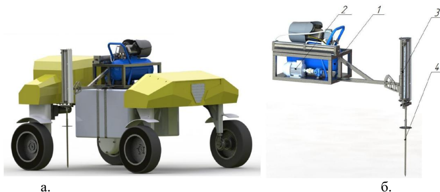
1 – компрессор; 2 – электродвигатель и насос; 3 – стрела с устройством линейного смещения инжектора и линейными направляющими; 4 – остроконечная трубка
