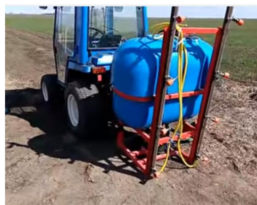
Рисунок 6 – Малогабаритные опрыскиватели: а – на базе трактора МТЗ-82 (опрыскиватель садовый БЛ-600); б – на базе трактора Т-25
