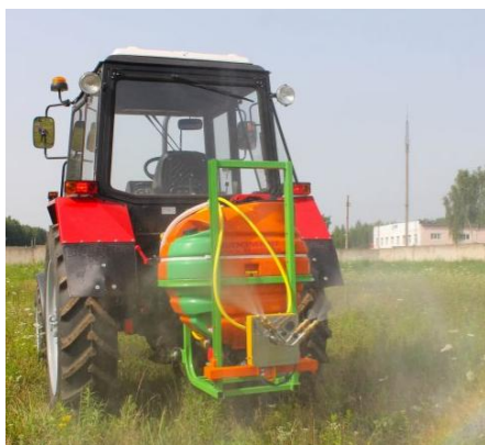
Рисунок 6 – Малогабаритные опрыскиватели: а – на базе трактора МТЗ-82 (опрыскиватель садовый БЛ-600); б – на базе трактора Т-25
