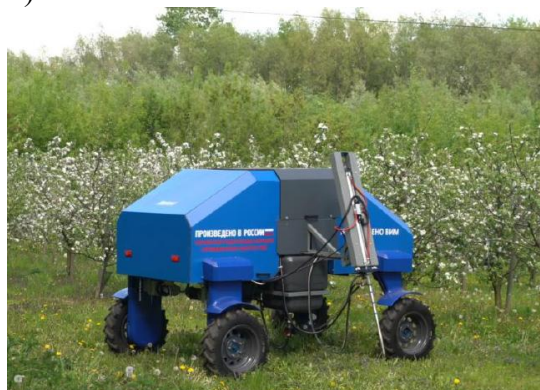
Рисунок 4 – Опытный образец универсальной роботизированной платформы для внутрипочвенной подкормки плодовых насаждений в садоводстве
