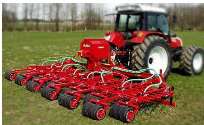
Рисунок 2 – Орудие для досева и подсева (Pneumaticstar)
