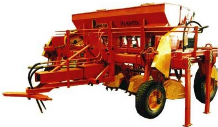
Рисунок 4 – Сеялка дернинная (СДК(П)-2,8)
