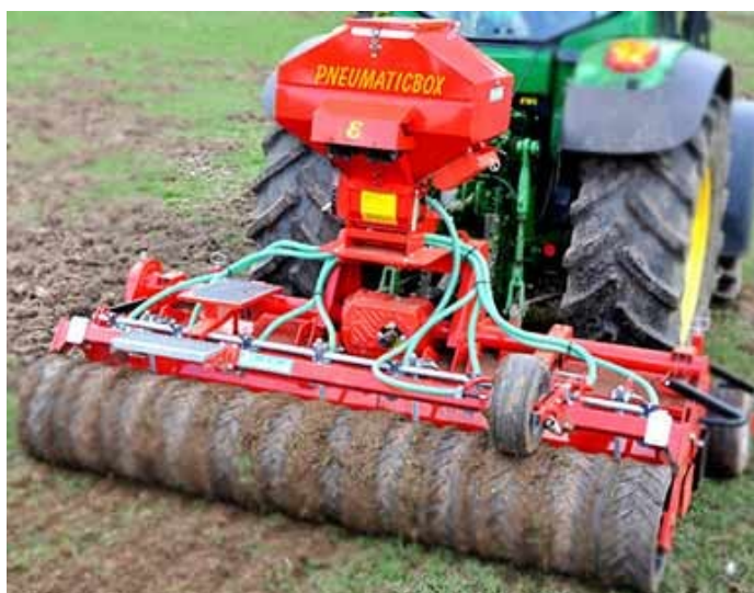
Рисунок 6 – Сеялка пневматическая (Pneumaticbox/P-Box Speed)
