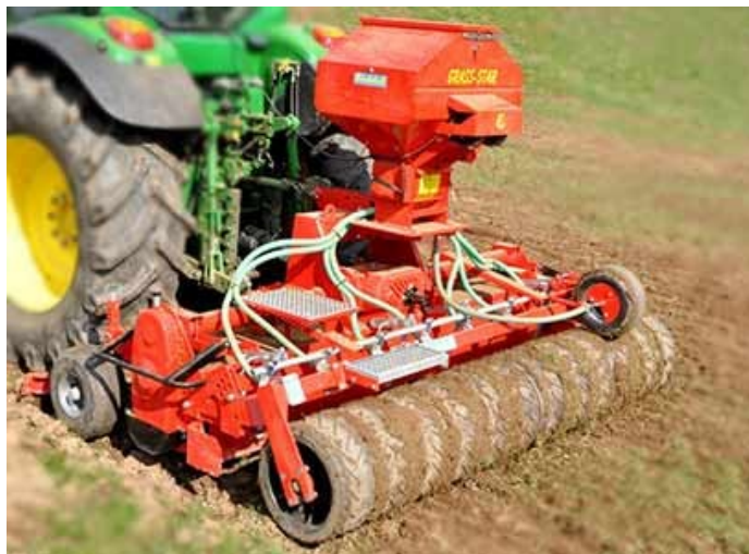
Рисунок 5 – Сеялка прямого посева (Grass-Star)
