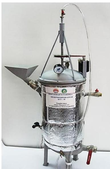
*Рисунок 1 – Общий вид биореактора*
