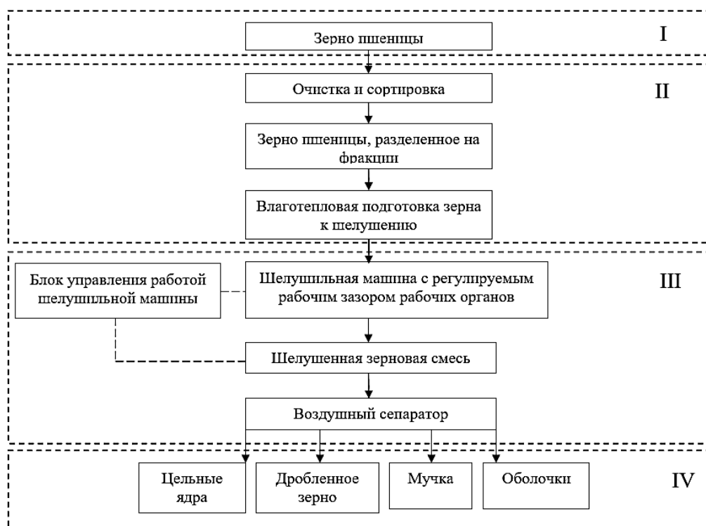
Рисунок 1 – Совершенствованная технологическая схема шелушения зерна пшеницы
