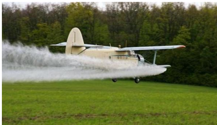
Рисунок 3 – Использование самолета АН-2 при обработке посевов сельскохозяйственных культур
