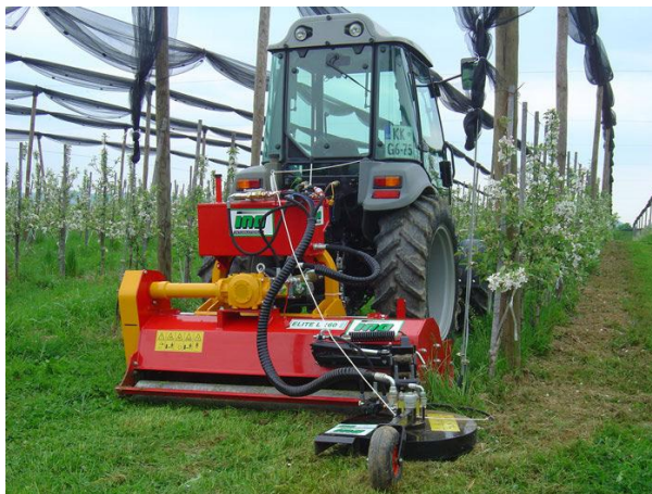
Рисунок 2 – Косилка-измельчитель с выдвижной секцией для ухода за приствольными полосами плодовых насаждений
