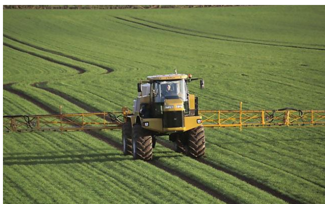
Рисунок 2 – Образование колеи при обработке посевов сельскохозяйственных культур самоходными штанговыми опрыскивателями
