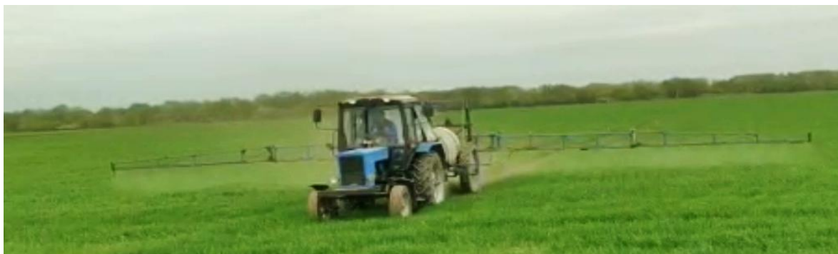
Рисунок 1 – Широкозахватный штанговый опрыскиватель при внесении биопрепаратов в баковой смеси
