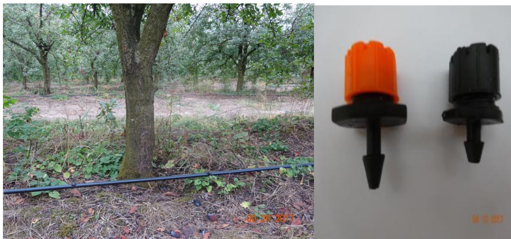
Рисунок 3 – Капельная линия многолетнего использования и капельницы с диапазоном регулирования 1-70 л/час
