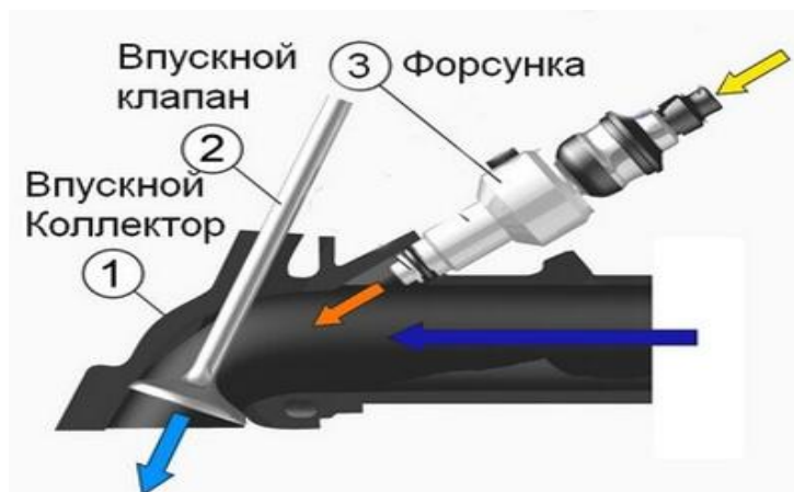
Рисунок 1 – Система распределенного впрыска во впускной коллектор
