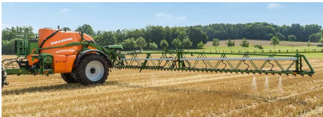
Рисунок 3 – Прицепной опрыскиватель UX AmaSpot с интеллектуальной системой сенсорных форсунок для дифференцированного внесения средств защиты растений
