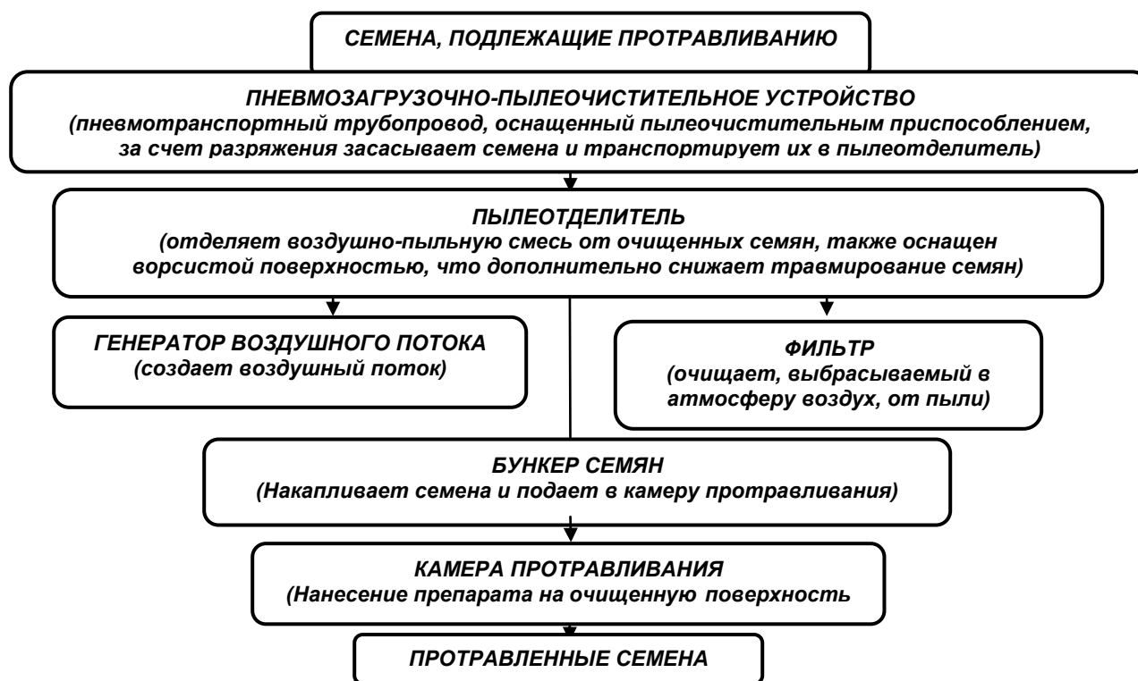
Рисунок 2 – Функциональная модель протравливателя семян с пневмозагрузочно-пылеочистительным устройством
