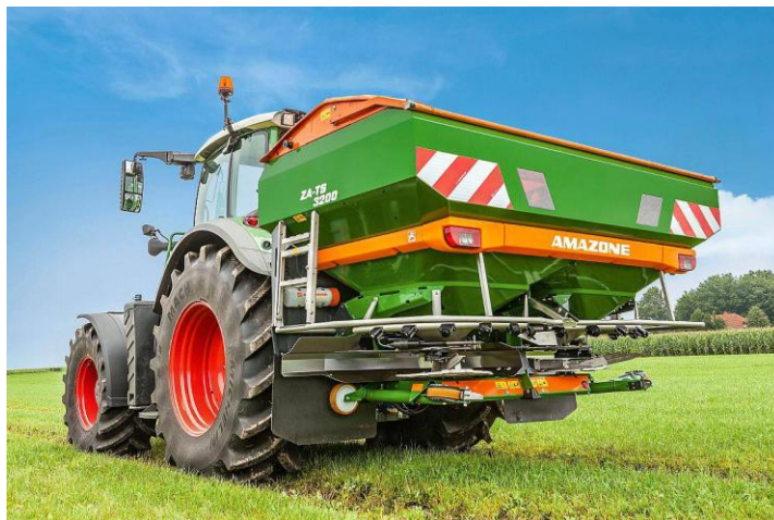
Рисунок 1 – Разбрасыватель ZA-TS для дифференцированного внесения минеральных удобрений
