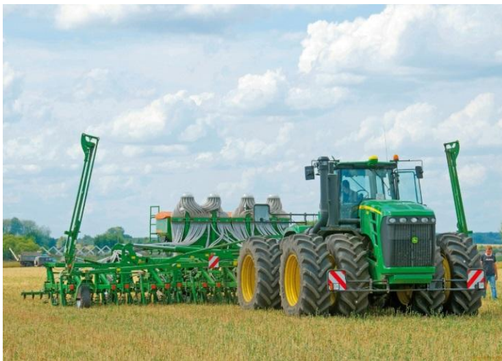
Рисунок 2 – Сеялка Primera DMC 9000 для дифференцированного посева
