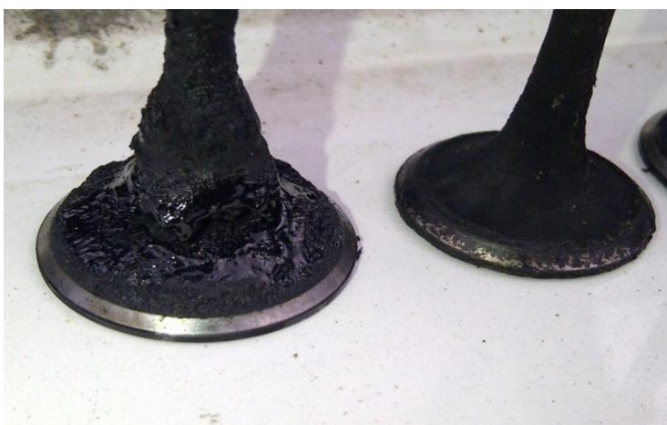
Рисунок 3 – Нагар на впускном клапане при непосредственном впрыске бензина
