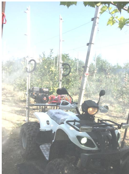
Рисунок 2 – Малогабаритный ультрамалообъемный опрыскиватель для защиты плодовых насаждений в крестьянских (фермерских) и приусадебных хозяйствах.
