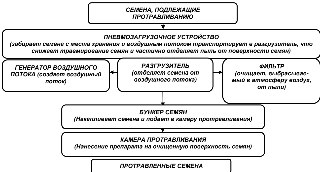
Рисунок 1 – Функциональная модель протравливателя семян с пневмозагрузочным устройством
