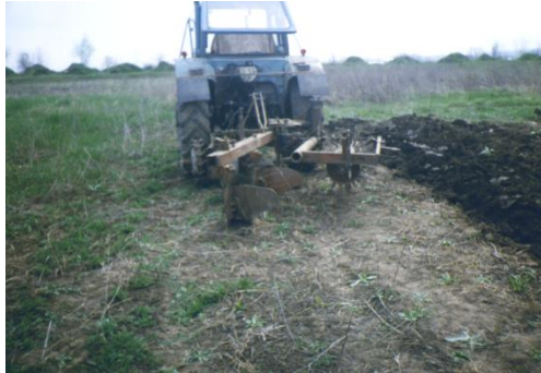
Рисунок 1 – Конструктивно-технологическая схема (а) и опытный образец комбинированного пахотного агрегата с ротационным рабочим органом: с приводом от левого колеса трактора в рабочем (б) и транспортном (в) положениях
