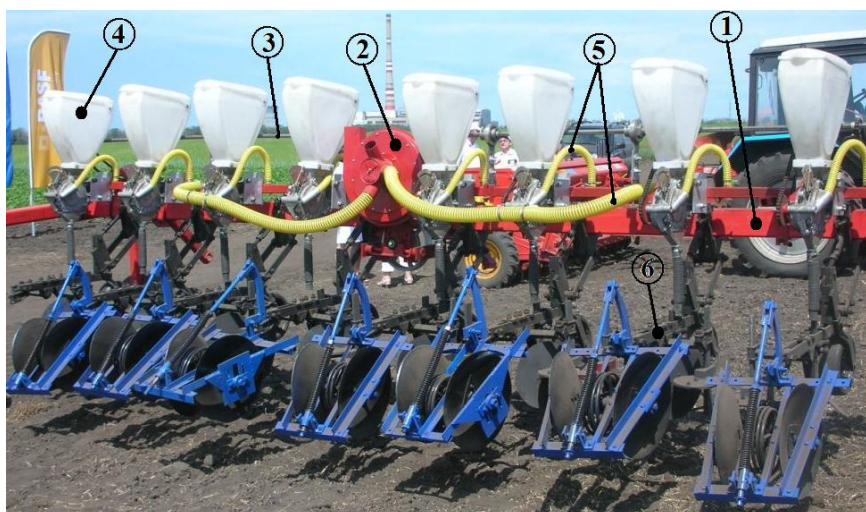
Рисунок 1 – Гребневая сеялка: 1 – рама сеялки; 2 – вентилятор; 3 – приводной вал; 4 - семенной ящик с высевными аппаратами; 5 – воздуховоды; 6 – посевная секция
