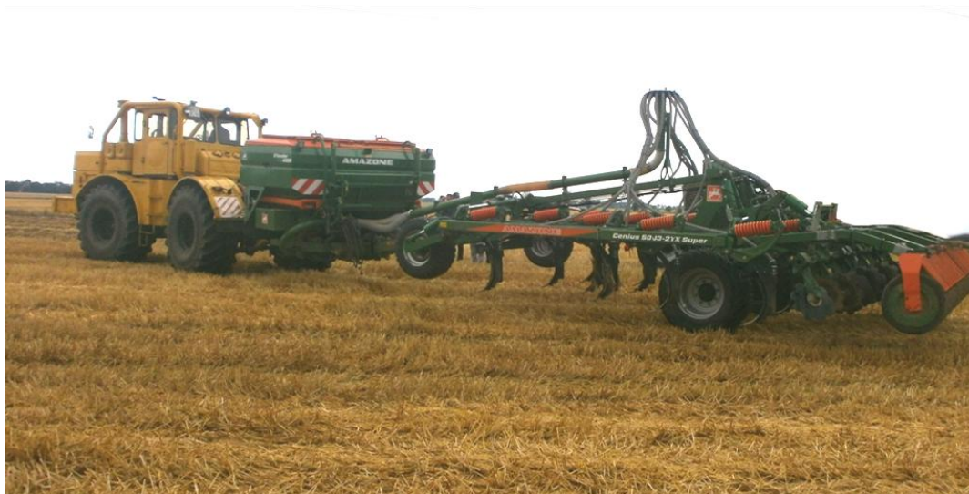
Рисунок 3 - Бункер XTender с культиватором Ctnius-TX для внутрипочвенного внесения удобрений
