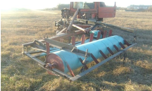
Рисунок 2 – Конструктивно-технологическая схема (а) и опытный образец комбинированного пахотного агрегата с ротационным рабочим органом: с приводом от левой звездочки гусеницы трактора (в, г)
