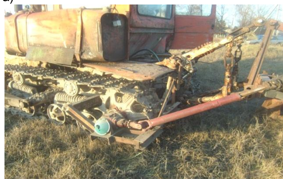
Рисунок 2 – Конструктивно-технологическая схема (а) и опытный образец комбинированного пахотного агрегата с ротационным рабочим органом: с приводом от левой звездочки гусеницы трактора (в, г)
