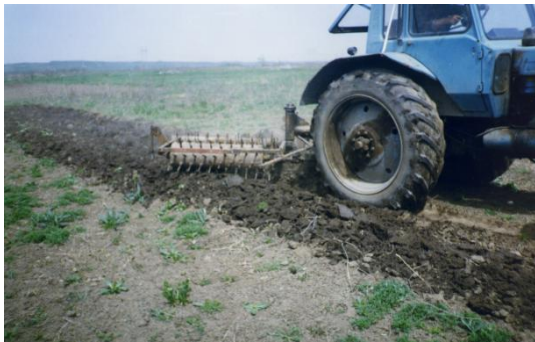
Рисунок 1 – Конструктивно-технологическая схема (а) и опытный образец комбинированного пахотного агрегата с ротационным рабочим органом: с приводом от левого колеса трактора в рабочем (б) и транспортном (в) положениях
