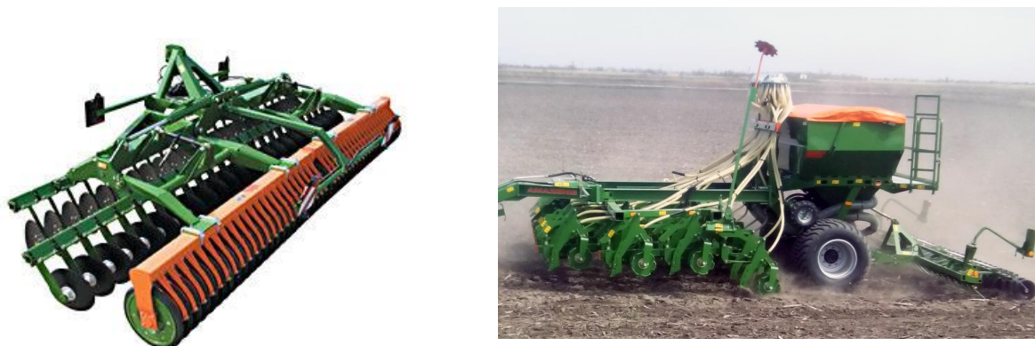
Рисунок 1 – Техника для влагосберегающих технологий фирмы «Amazone-Werke» (Германия – Россия – Самара): а) дисковая борона «Katros-6001»; б) сеялка прямого посева «ДМС-Primera 300»
