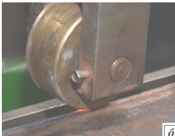
Рисунок 2 – Электромеханическая закалка лемеха:
