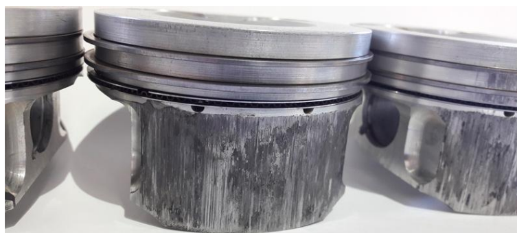
Рисунок 2 – Задиры на юбках поршней
