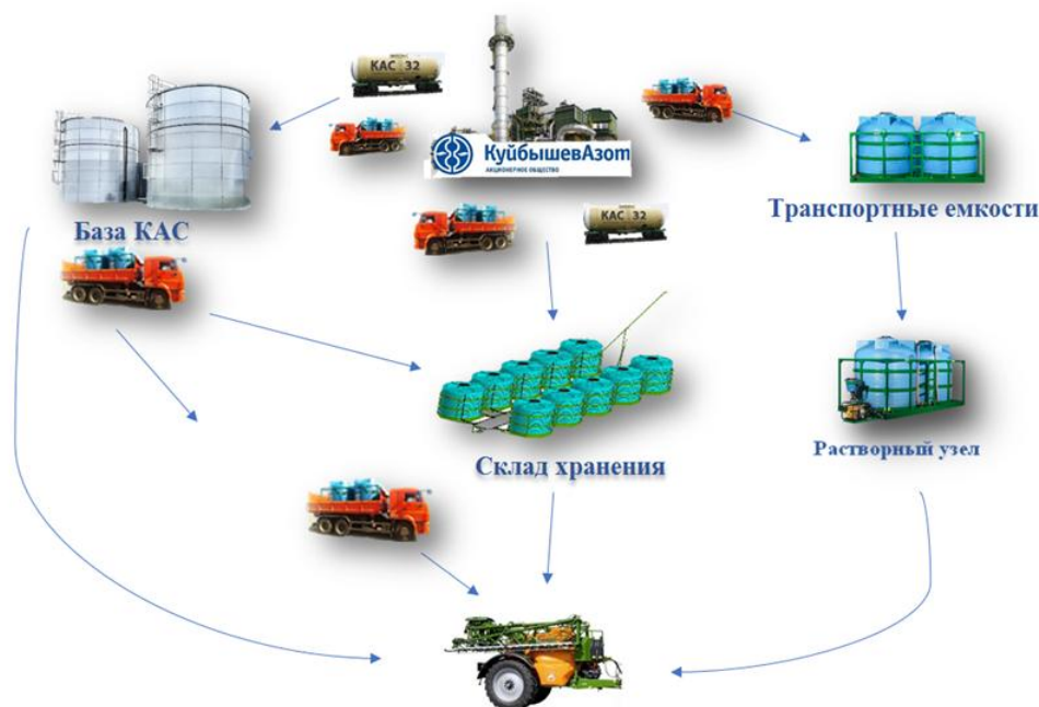
Рисунок 1 – Логистическая схема доставки произведенных на ПАО «Куйбышев Азот» жидких удобрений железнодорожным и автомобильным транспортом на базы, склады хранения и к сельхозагрегатам (на схеме опрыскиватель, оборудованный для внесения КАС АО «Евротехника») с использованием пластиковых емкостей и растворного узла для баковых смесей (ООО «Регион»)
