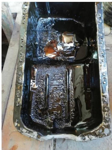
Рисунок 1 – Последствия раскоксовки двигателя Демексидом
