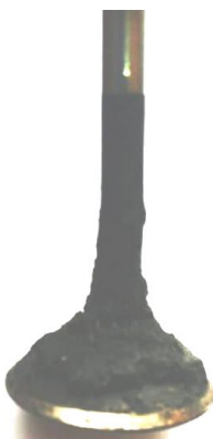
Рисунок 2 – «Шапка» нагара на впускном клапане ДВС с непосредственным впрыском топлива в цилиндр
