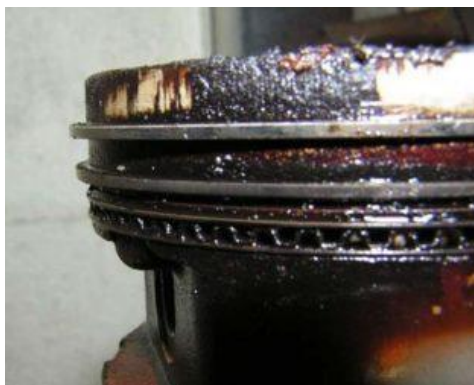
Рисунок 1 – Последствия работы двигателя в тяжелых условиях
