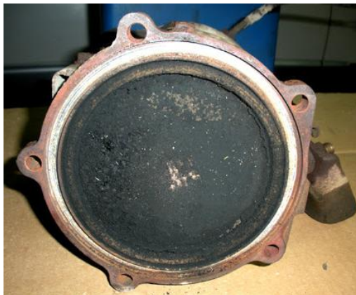
Рисунок 2 – Катализатор, забитый продуктами сгорания
