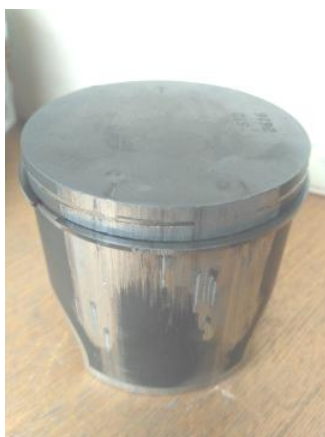
Рисунок 2 – Последствия прихвата поршня к цилиндру
