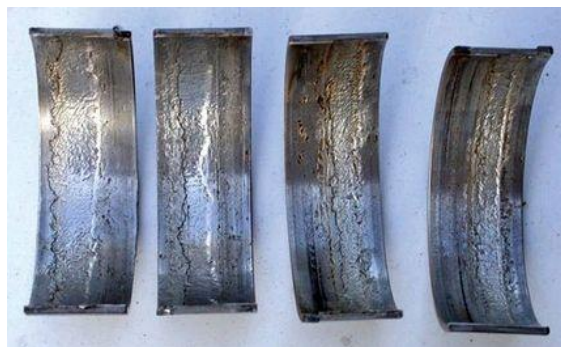
Рисунок 3 – Протертые вкладыши шатунов
