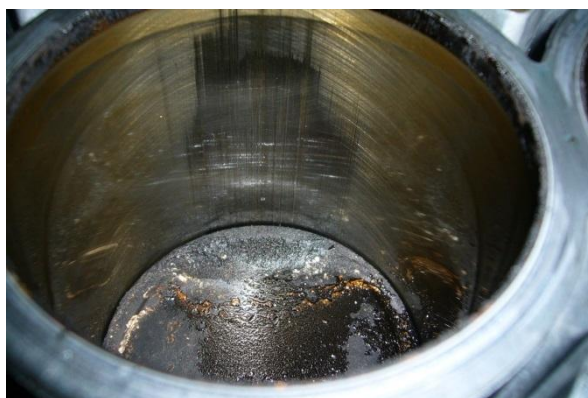
Рисунок 1 – Задиры на стенке цилиндра
