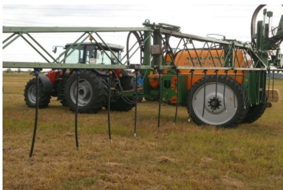
Рисунок 1 – Агрегат из опрыскивателя AMAZONE (АО «Евротехника») со шлангами удлинителями для внесения КАС; следы КАС при внекорневой подкормке
