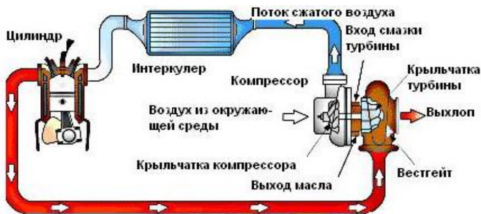
Рис. 1 – Принцип работы наддува от отработавших газов
