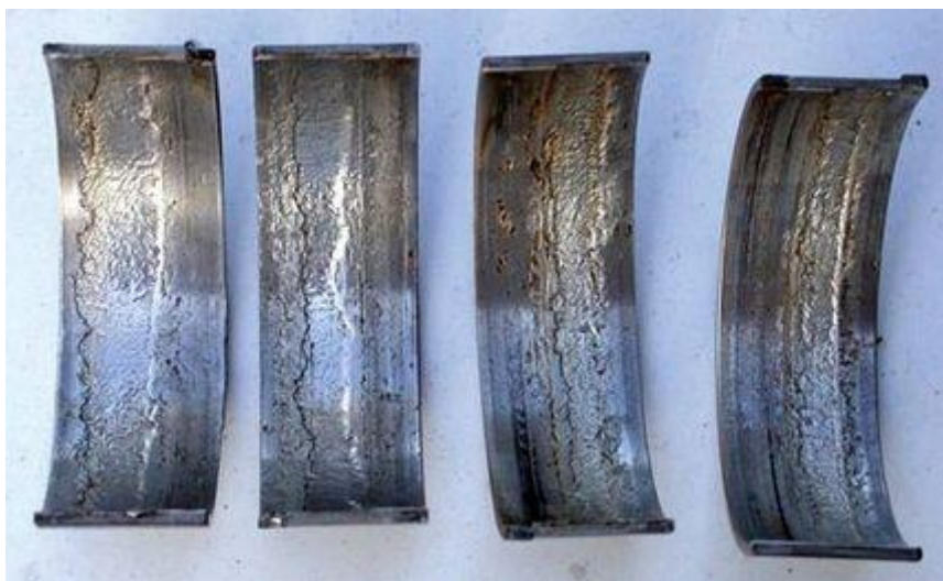
Рис. 2 – Протертые шатунные вкладыши
