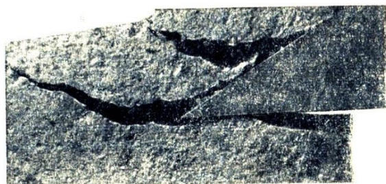
Рис. 1 – Реальная картина разрушения сильно увлажненного суглинка при резании клином с углом \delta = 30^\circ [1]
