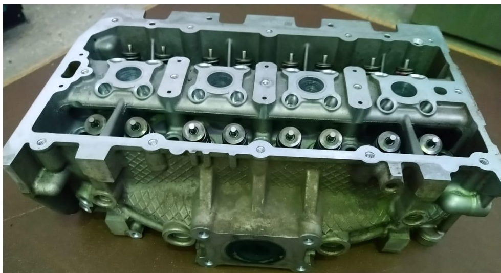
Рис. 2 – Головка блока цилиндров со встроенным выпускным коллектором
