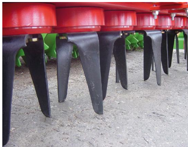
Рисунок 4 – Форма ножей почвофрезы UNIA HERMES
