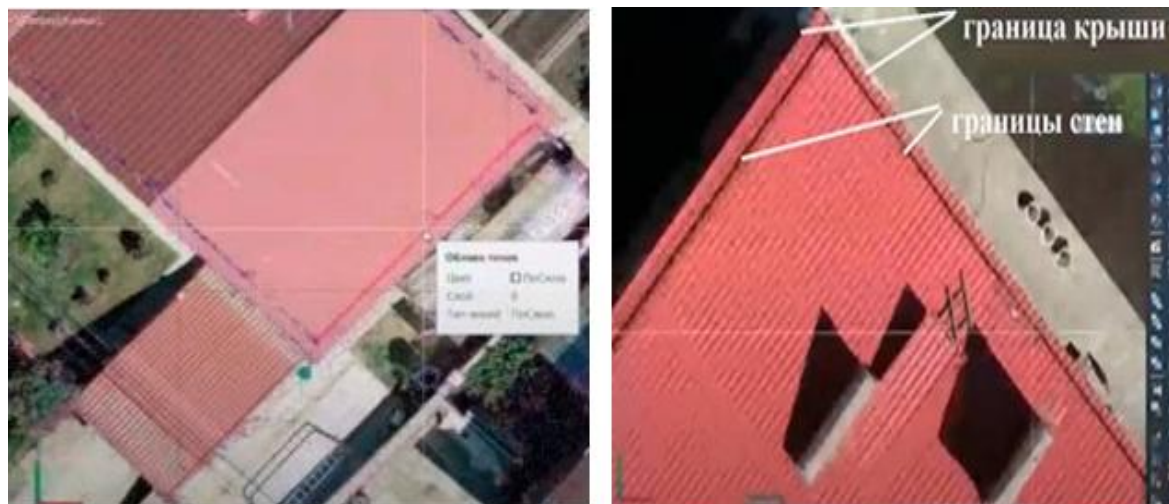
Рисунок 4 – Совмещенное изображение облака точек и ортофотоплана
