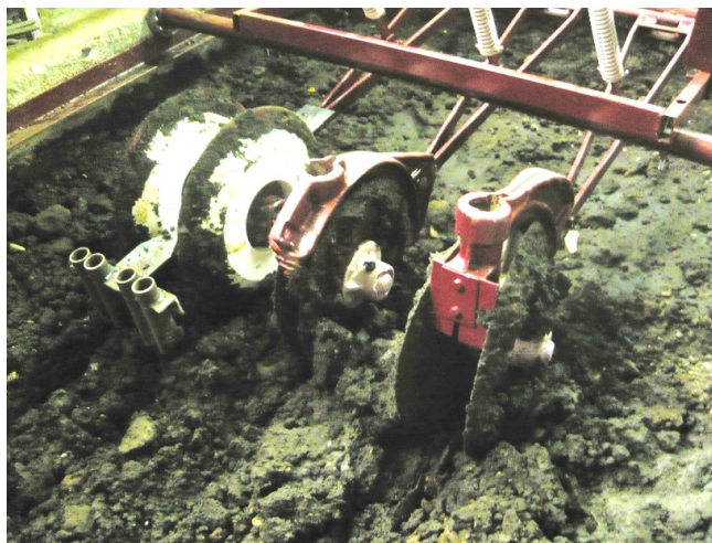
Рисунок 1 – Экспериментальный бороздоформирующий рабочий орган в почвенном канале
