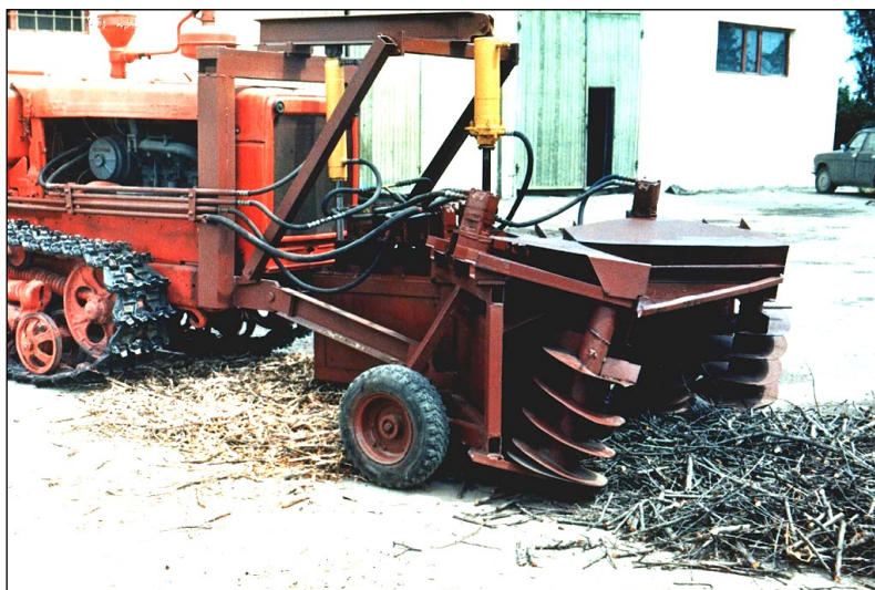
Рисунок 2 – Опытный образец подборщика-измельчителя срезанных ветвей плодовых деревьев ПИВ-1
