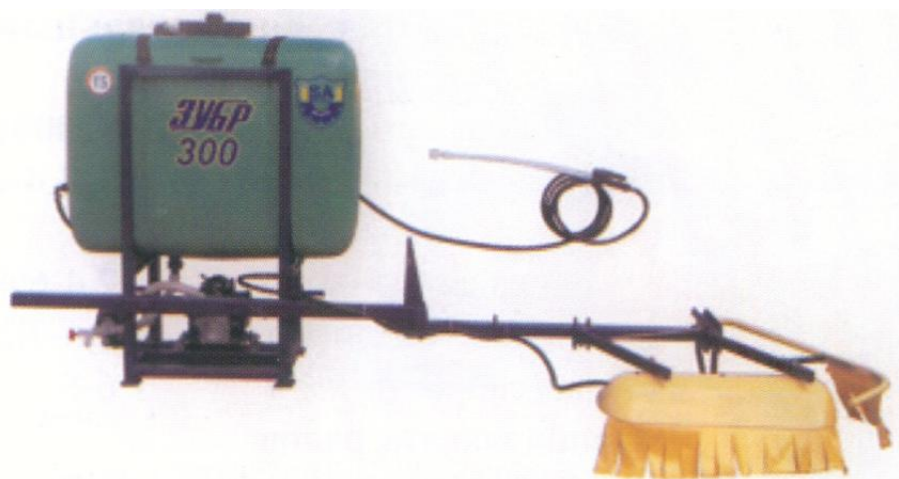
Рисунок 1 – Навесной штанговый опрыскиватель серии ЗУБР НШ, «ГЕРБИ» (Разработчик и изготовитель – ООО «СелАгро»)
