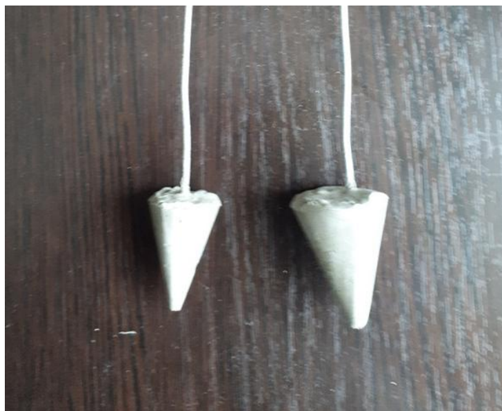
Рисунок 2 – Вид модели проволочного анкера с коническим наконечником, выполненного из бетона
