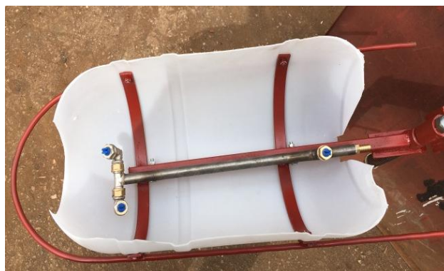
Рисунок 8 – Размещение распылителей на поворотной штанге
