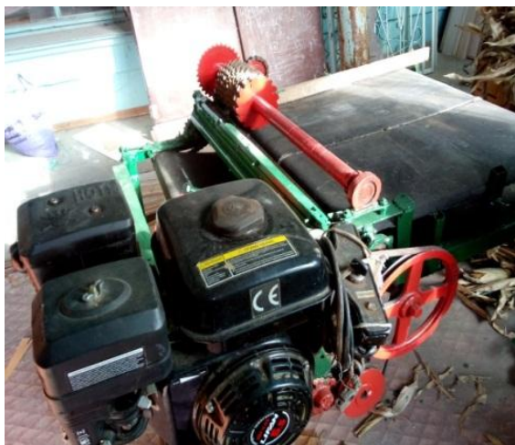
Рисунок 2 – Схема и общий вид измельчителя: 1 – стойка; 2 – двигатель; 3 – механизм привода; 4 – основной вал с режущими ножами; 5 – подающий вал с протирежущими ножами; 6 – вал с циркуляционными дисками; 7 – транспортер; 8, 9 – ведущий и ведомый валы транспортера; 10, 11 и 12 механизмы натяжения 10, 11 и 12 транспортера
