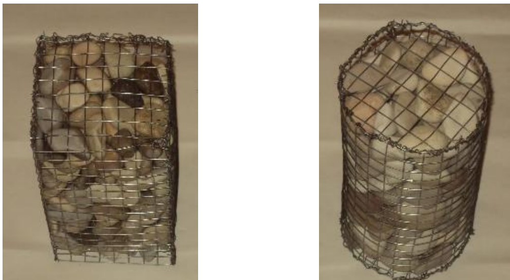
Рисунок 1 – Общий вид модельных образцов до испытания на сжатие
