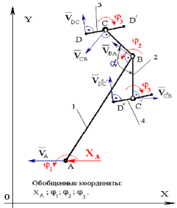
Рисунок 2 – Структурная схема окатывающей косилки
