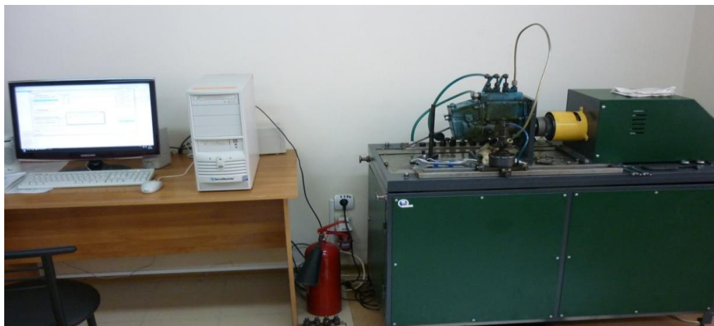
Рисунок 1 – Стенд КИ-35478 для испытания и регулировки топливного насоса
