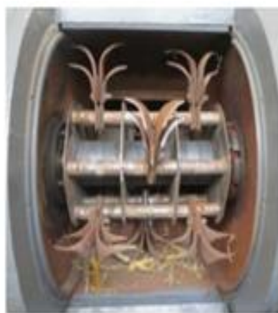
Рисунок 4 – рабочий орган измельчителя: а – барабан; б – комбинированный нож; 1 – поперечное серповидное лезвие; 2 – вертикальное клиновидное лезвие
