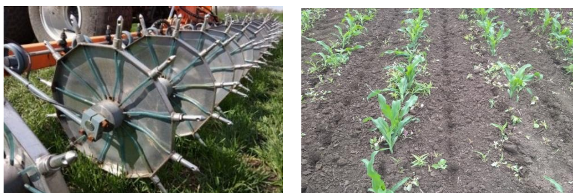
Рисунок 4 – Следы от инъекторных игл агрегата «Пегас-Агро» при внесении КАС на кукурузе
