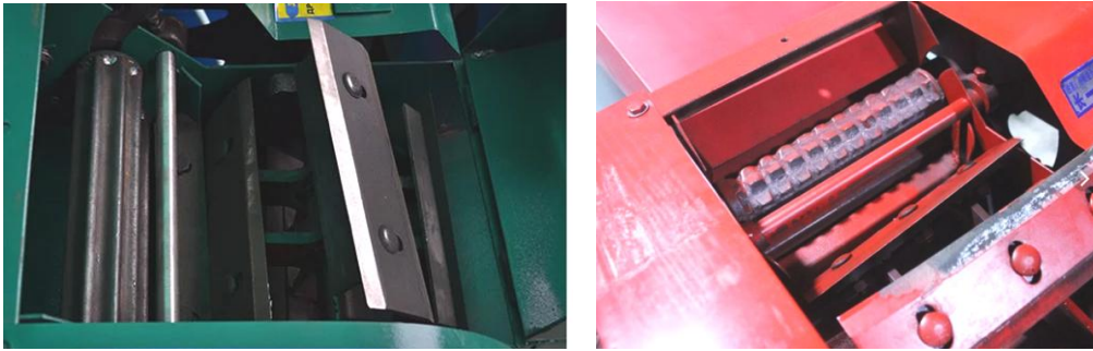
Рисунок 2 – Рабочие органы измельчителей грубых толстостебельных кормов
