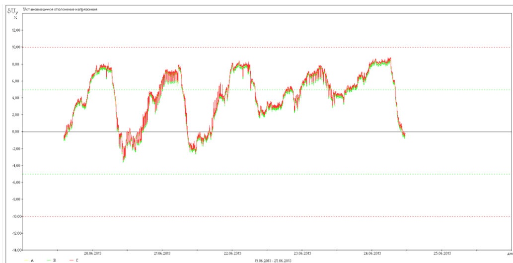
Рисунок 1 – Результаты измерения установившегося отклонения напряжения фаз
