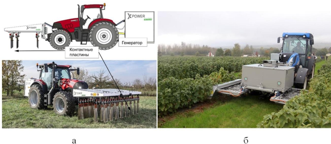
Рисунок 1 – Агрегаты для электропрополки компаний Case IH AgXtend (а) и RootWave (б)
