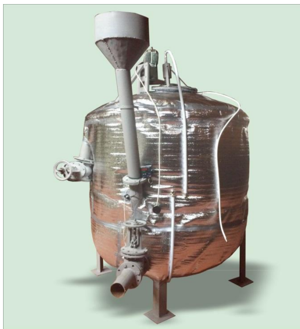
Рисунок 1 – Экспериментальная лабораторная биогазовая установка
