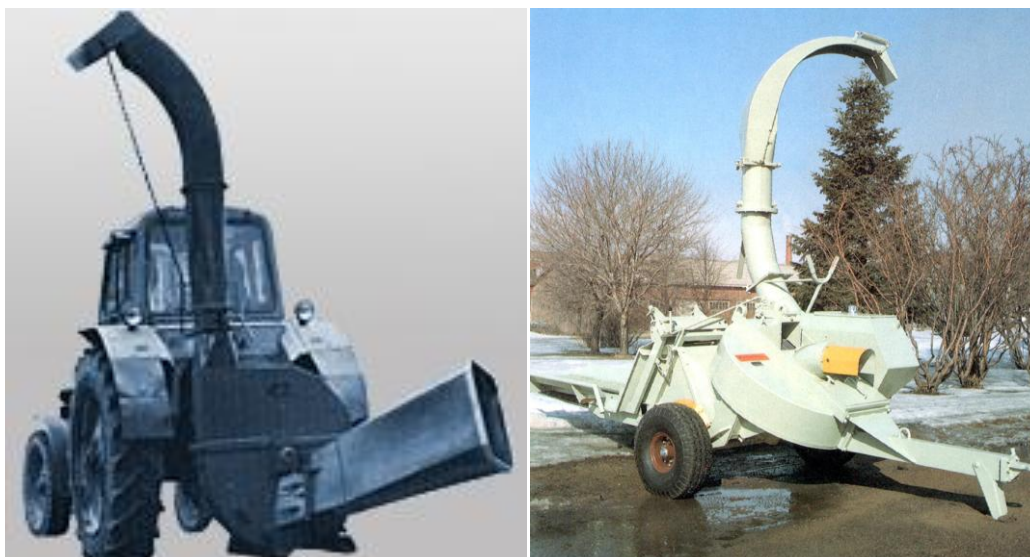
а. б. Рисунок 2 – Позиционные измельчители обрезков плодовых деревьев: ДОП-1 (а) и УВП-1Б (б)
