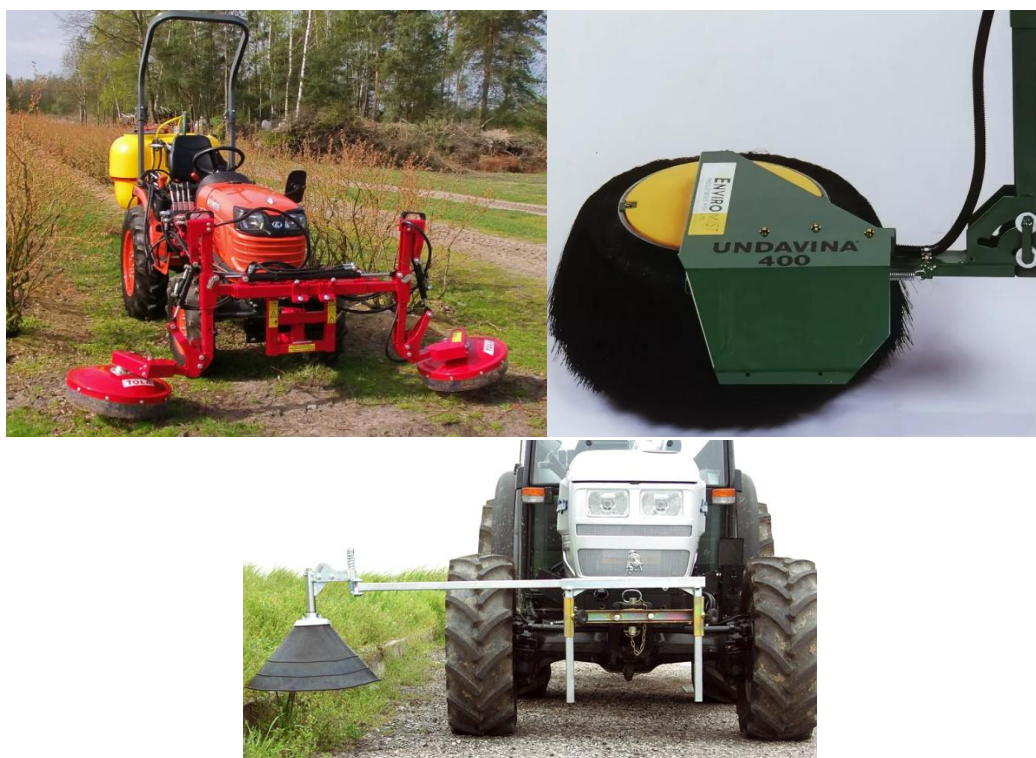
Рисунок 3 – Гербицидные установки с дисковым рабочим органом с защитным фартуком из щеточного рабочего органа
