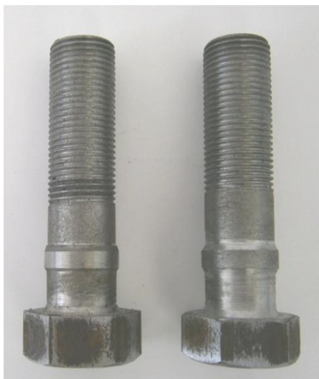
Рисунок 3 – Винты для соединения корпуса подшипника вала измельчителя к раме кормоуборочного комбайна «Дон-680М»
