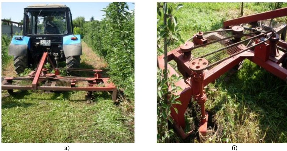
Рисунок 5 – Общий вид агрегата для ухода за междурядьями и приствольными полосами плодовых насаждений: косилка-измельчитель (а) и фрезерный рабочий орган (б)
