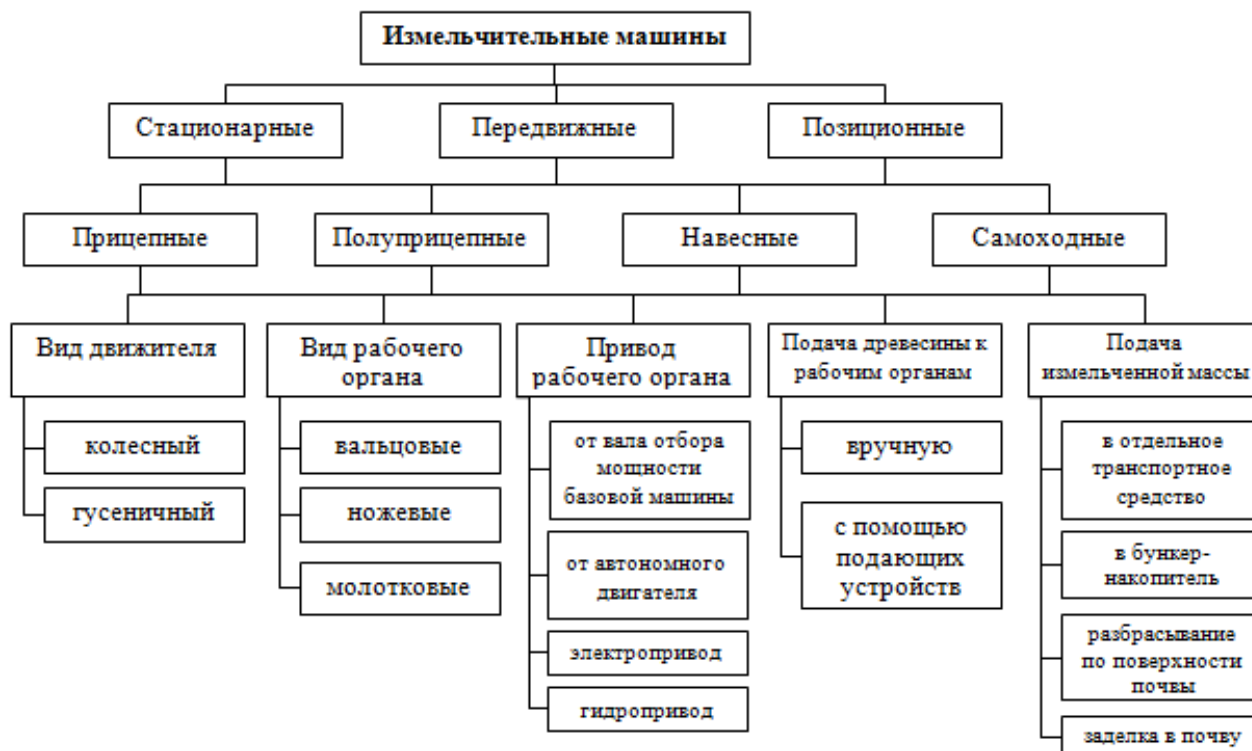
Рисунок 1 – Классификационная схема измельчителей для утилизации обрезков ветвей
