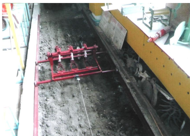
Рисунок 1 – Вид на почвенный канал после прохода тележки с экспериментальными сошниками, установленными в один ряд с расстоянием междурядий 0,125 м при скорости движения 4 м/с
