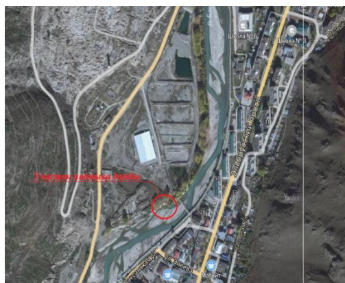
Рисунок 1 – Ситуационный план расположения хвостохранилища №1 ТВМК с обозначением участка подмыва откоса дамбы обвалования (в красном круге)
