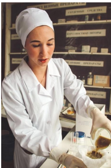
Рисунок 1 – Процеживаем рубцовое содержимое через 4 слоя марли в лабораторный стакан
